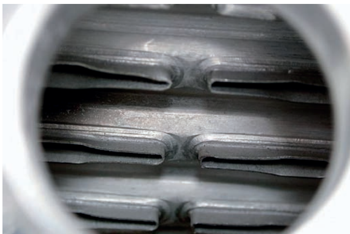
Овальные трубки в разрезе
