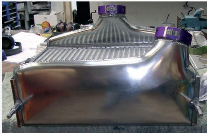
Полностью алюминиевые радиаторы спортивных автомобилей изготавливаются под конкретный двигатель
