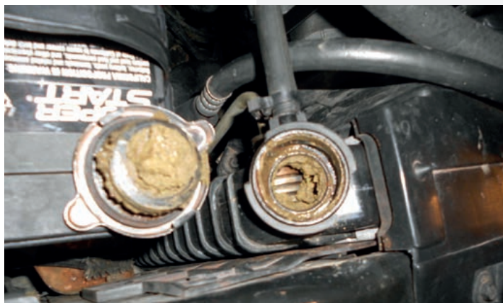
Антикоррозионные присадки, содержащиеся в антифризах разных типов, так же могут входить в химическую реакцию между собой, вызывая выпадение осадков
