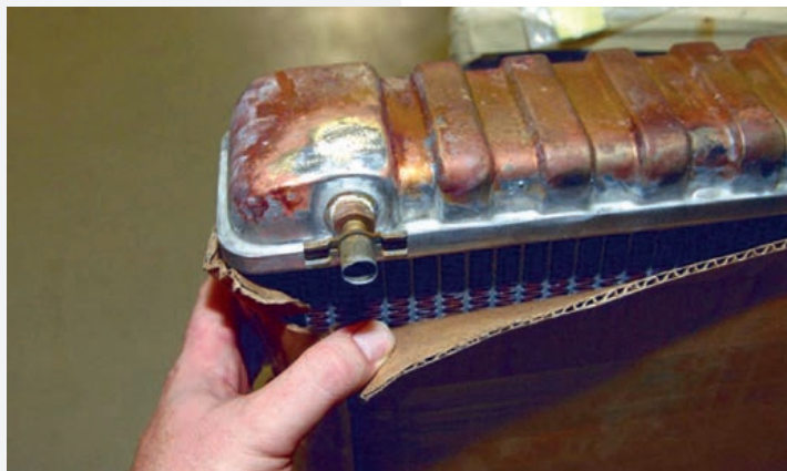
Медные паяные радиаторы потеряли популярность из-за высокой стоимости меди и трудоемкого изготовления
