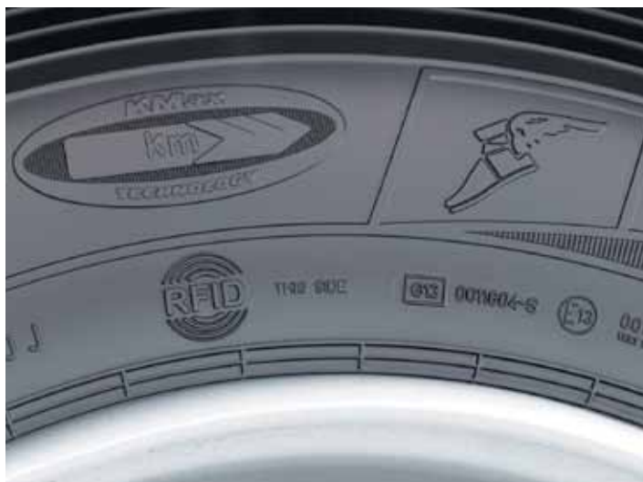
Шина с надписью RFID имеет встроенный микрочип
