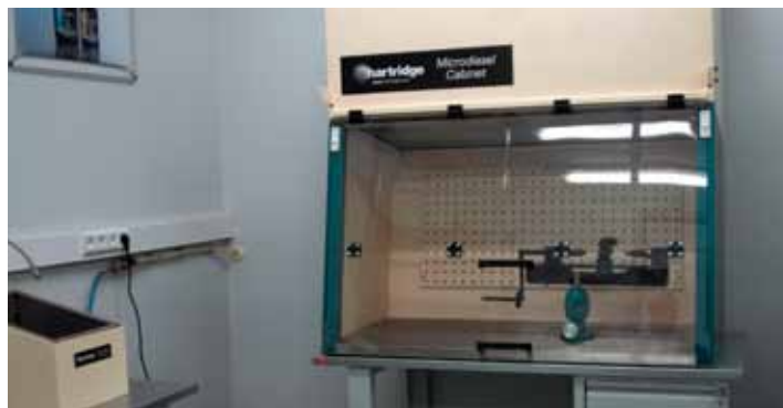
«Чистая комната» – рабочее место для ремонта форсунок.
