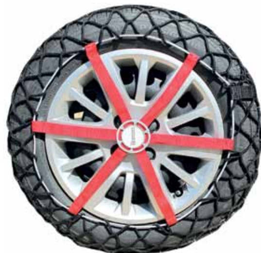
Инновационная цепь. Используется там, где обычная цепь не умещается в колесной арке
