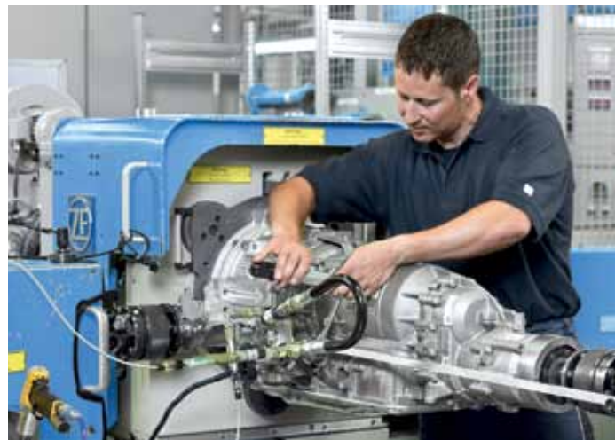
В заключение выполняется проверка функционирования на испытательном стенде
