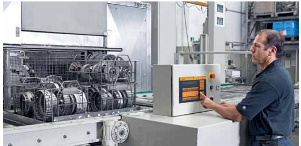
Перед сборкой высокотехнологичный процесс обеспечивает тщательную очистку всех элементов
