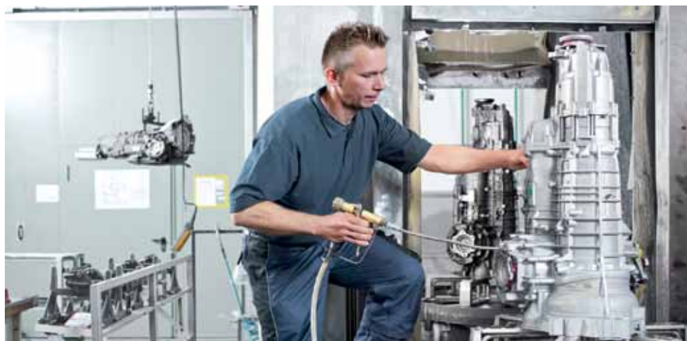
Первый этап восстановительного ремонта – тщательная очистка внешней поверхности
