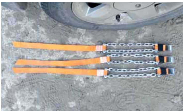
Браслеты противоскольжения «Антибукс» можно быстро установить, даже если машина застряла в грязи
