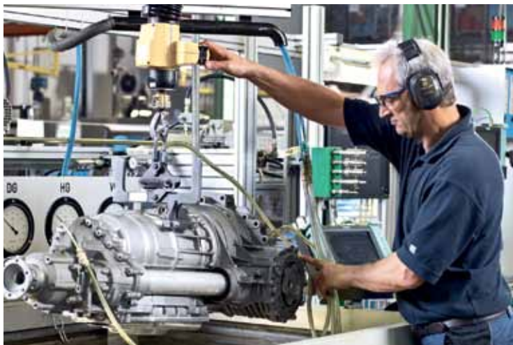
Испытание сухим и влажным методами позволяет убедиться в отсутствии утечек или выявить таковые
