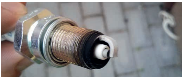
Белый сухой налет и следы копоти на свечах говорят о том, что используется обедненная топливная смесь
