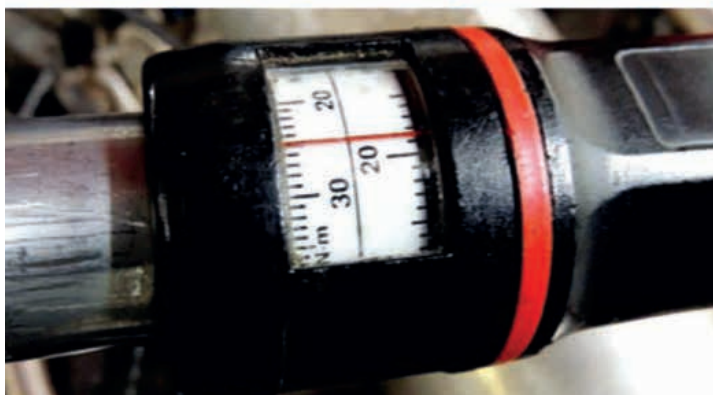
При монтаже свечей зажигания необходим динамометрический ключ
