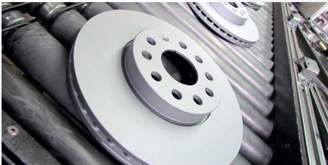
На диски наносится специальное покрытие, повышающее их коррозионную стойкость
