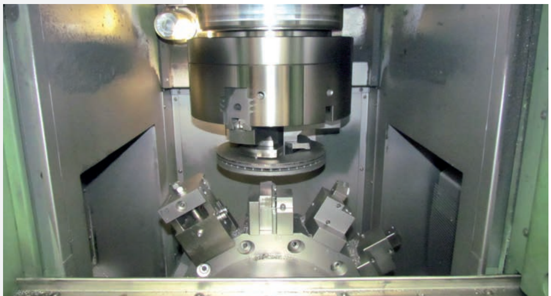
Обрабатывающий станок последовательно выполняет несколько фрезеровочных операций
