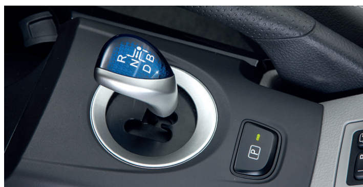
Рукоятка блока переключения режимов, заменяющая рычаг КПП. Toyota RAV4EV второго поколения
