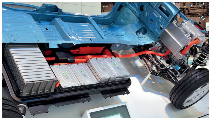
Nissan Leaf. Размещение АКБ – главная проблема в дизайне электромобилей
