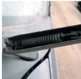
Увеличивать прижимную силу, меняя пружину на более жесткую, нет смысла – проще и зачастую дешевле заменить щетки дворников.
