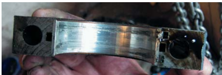
Провернувшийся из-за плохой смазки пары трения вкладыш «убил» крышку коренного подшипника.
