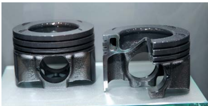
Поршни с короткими юбками для высокооборотных дизелей изготавливаются из особых сплавов алюминия, способных выдерживать большие тепловые и механические нагрузки.
