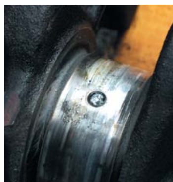
В условиях ограниченной смазки материал вкладыша буквально забивает масляные магистрали коленчатого вала.
