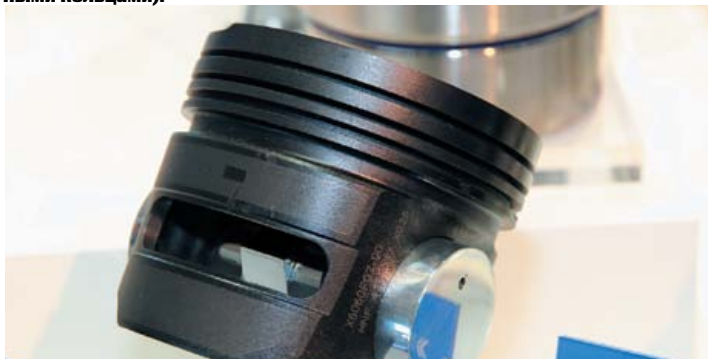
Верх совершенства – поршень облегченной конструкции со специальным покрытием. Ресурс такой детали при соблюдении правил эксплуатации мотора составляет сотни тысяч километров пробега.
