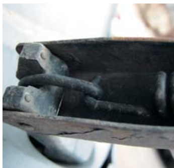
Фотоб. – Самый простой способ увеличить жесткость растянувшейся в процессе эксплуатации пружины – укоротить ножку ее крепления.
