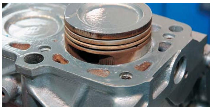
Зазор между поршнем и цилиндром играет огромное значение как с точки зрения обеспечения ресурса поршня, так и технических характеристик мотора.
