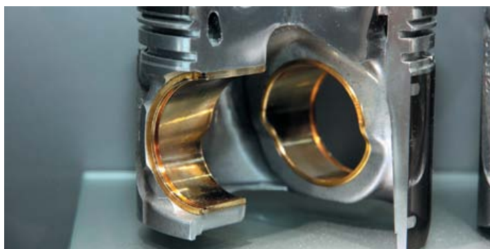
Современные технологии изготовления поршней позволяют интегрировать в их конструкцию детали из разнородных металлов, обеспечивая усиление тех или иных зон (областей).
