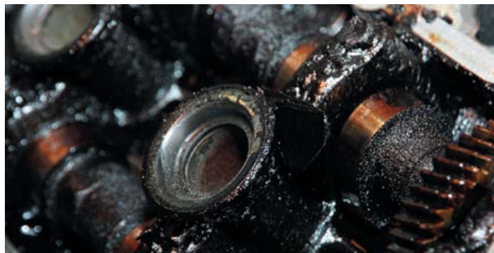
Из-за некачественного топлива смола откладывается не только на направляющих втулках клапанов, но и осаждается под крышной головкой блока цилиндров. Ситуацию усугубляет применение некачественного масла и его несвоевременная замена.
