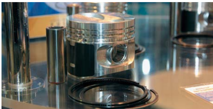
Практически все крупные производители поршней предлагают на рынке так называемые поршненомплеты, включающие в себя собственно поршень, поршневые кольца и поршневой палец (опционально со стопорными кольцами).
