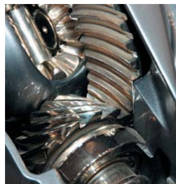
Для мостов (редукторов и гипоидных передач) в арсенале производителей есть присадки, предотвращающие эффект «сваривания» и выкрашивания зубьев шестерен при их работе с максимальной нагрузкой.
