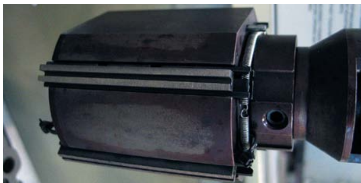
На ресурс поршней и поршневых колец танне влияет и применяемая при ремонте технология хонингования. Именно поэтому ремонтные мастерские не экономят на оборудовании и брусках для хонингования.
