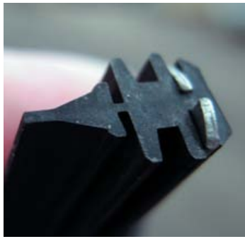
Обратите внимание на кромку резиновой ленты. Край должен быть плоским и не иметь скруглений.
