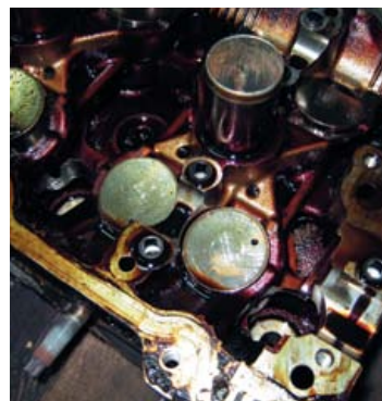
Смолы в топливе способны за короткий срок «убить» гидромомпесаторы. Если клапана «застучали», никакая промывка системы смазки уже не поможет.
