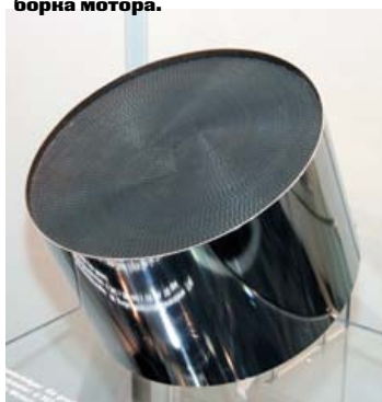
Если присадки в топливо некачественные и содержат химические элементы, «убивающие» катализатор, то последний быстро выходит из строя, а забитые окислами соты создают высокое противодавление в выпускной системе. Явный признак тому – потеря мощности двигателя.
