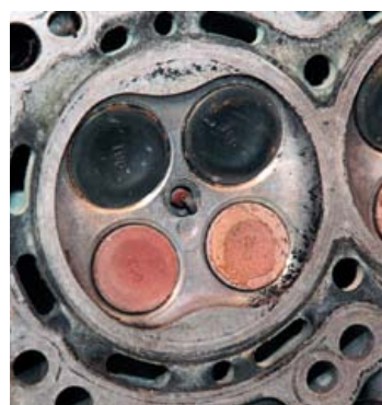
Классика жанра – работа мотора на бензине с большим содержанием железосодержащей присадки. Свидетельство тому – красный налет на изоляторе свечи. Итог заправки некачественным топливом – переборна мотора.
