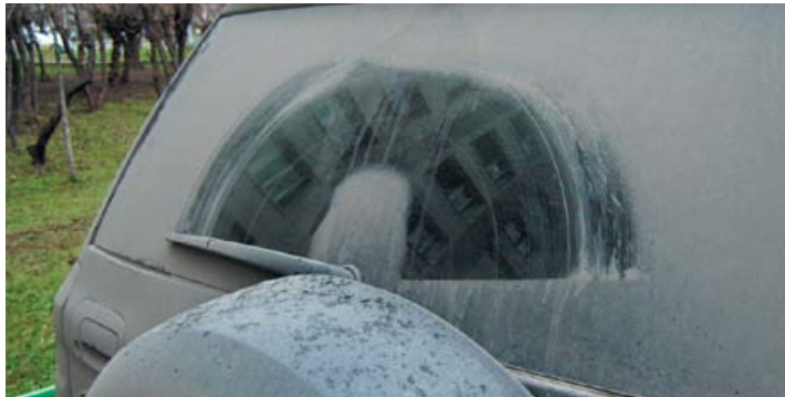
Типичный пример «убийства дворника» – работа стеклоочистителя без орошения стекла водой.
