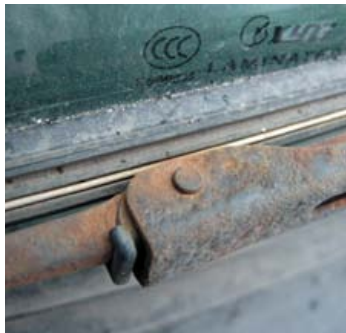
Пораженный окислами шарнир теряет подвижность, и щетка плохо прижимается к стеклу.
