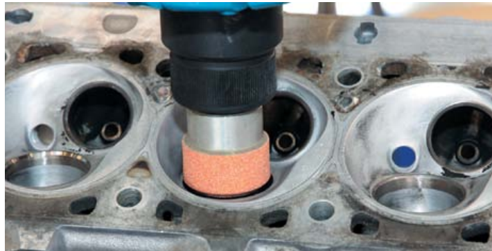
При медленном сгорании заряда вследствие заправки автомобиля некачественным топливом процесс окисления горючей смеси нередко заканчивается уже при открытом клапане. Итог – прогар седла и тарелки. Без ремонта головки вернуть мотору здоровье не удастся.
