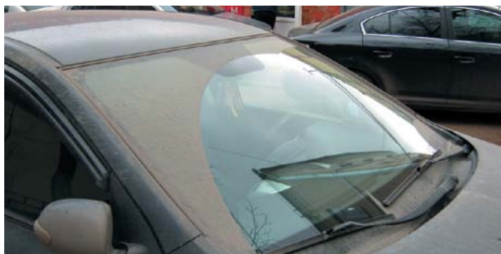
Дворники с простой кинематикой движения не очищают стекло полностью. С механизмами, обеспечивающими сложную траекторию движения, обеспечивается практически 90 % очистка «лобовина».
