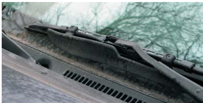
Спойлер не работает на малых скоростях, с которыми автомобили перемещаются в городе. Поток воздуха дополнительно прижимает «дворник» только на высоких скоростях.
