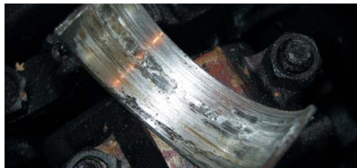
Разжиженное масло плюс холодный старт равно катастрофический износ коренного вкладыша. Избегать последствий помогли бы присадки, работающие в условиях масляного голодания.
