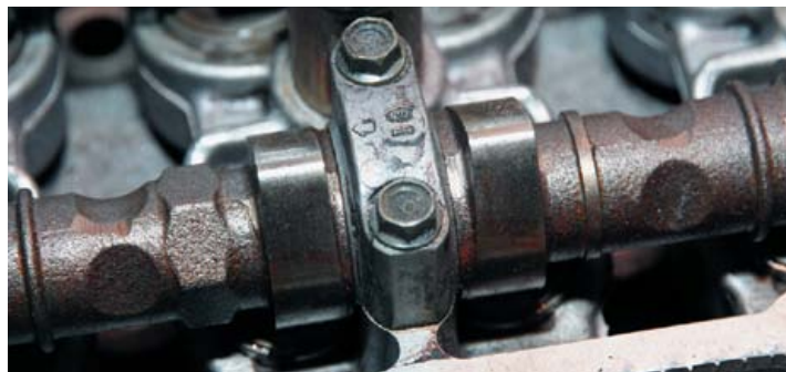
Если несгоревшее топливо попадает в картер мотора, то разжижения масла не избежать, также как и ускоренного износа кулачков распределительных валов.
