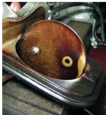
О качестве используемого топлива можно судить и по состоянию заслонок на дроссельных узлах.
