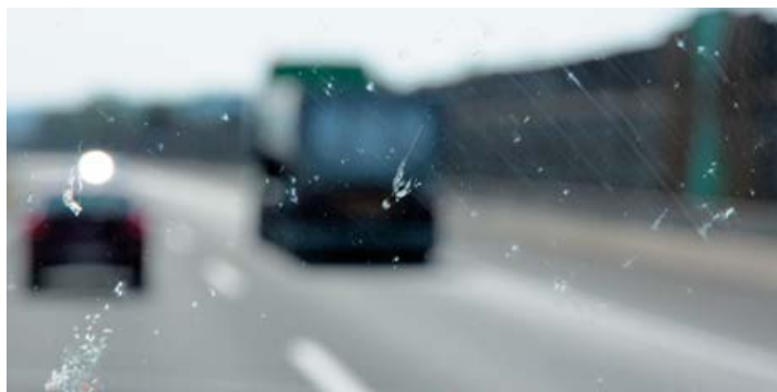
Щетки со сработавшимися кромками размазывают по стеклу смоченную пыль, сильно ухудшая обзор. Снимок сделан на скоростном автобане Германии.
