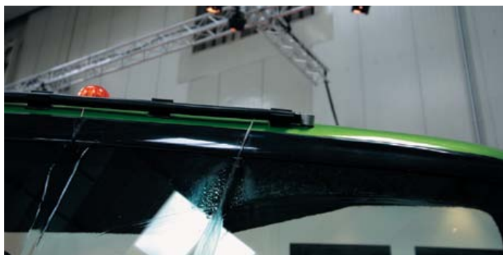
Накрышные системы омывания стекол значительно эффективнее форсуночных, прыскающих из-под стекла. Однако применить их можно на коммерческом транспорте или внедорожниках. Смонтированная на легковушках система портит внешний вид авто.
