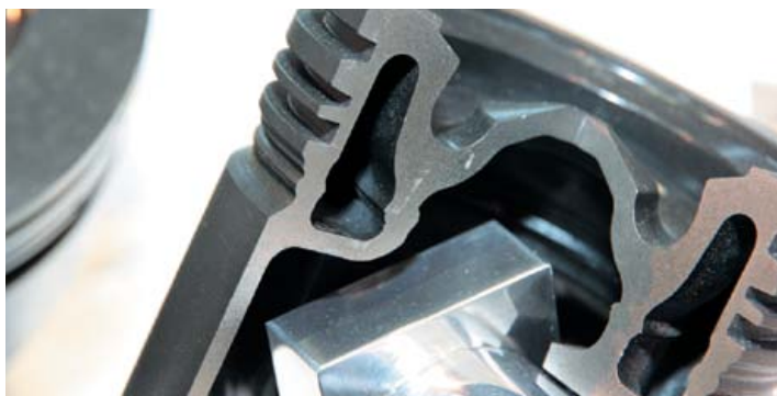
Для облегчения конструкции и снижения сил инерции поршни имеют пустотелую конструкцию. Их изготовление самое настоящее искусство, требующее применение сложного и дорогого технологического оборудования.
