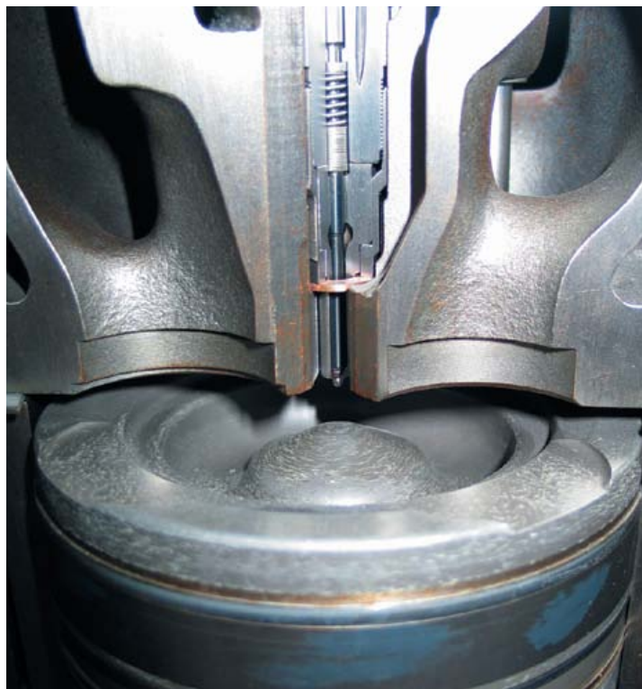
Днище поршня является частью камеры сгорания, поэтому его форма должна быть строго рассчитанной и изготовленной согласно лекалам.
