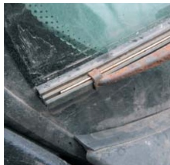
Для карнасных щеток важно отсутствие заеданий перемещения ленты в зажимах при изгибании каркаса. Идеально подобранные щетки не доходят до края стекла на считанные миллиметры, очищая большую площадь.
