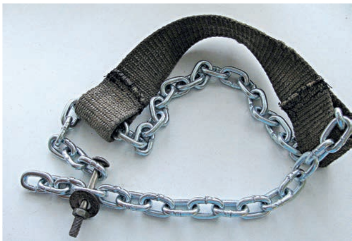
Браслет противоскольжения состоит из одной-двух цепочек, располагающихся поперек протектора и крепящихся на ободе колеса. Браслеты удобны для кратковременного преодоления сложных дорожных участков, на одном колесе устанавливают до 6 и более браслетов
