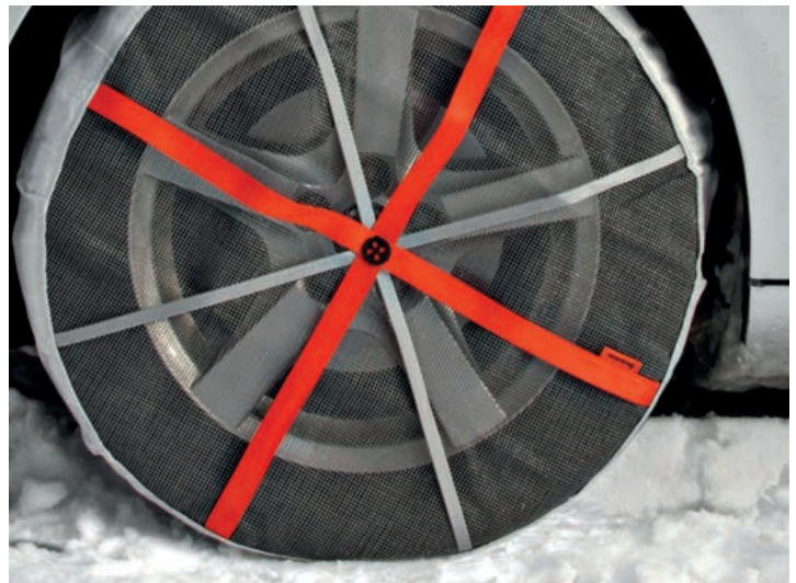
Текстильные колпаки противоскольжения, или «носни», получили популярность в Европе. Их главное преимущество – простота монтажа и относительно высокая эффективность. Приспособление занимает минимум места в багажнике, но оказывается необходимым в ситуации, когда зима покрывает дороги снегом
