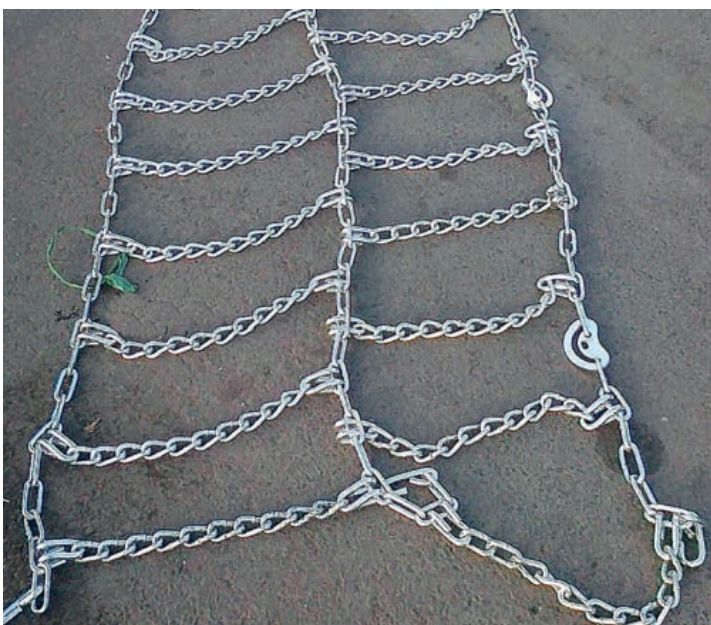
Перед установкой цепь раскладывают, а потом надевают на колесо. Установка занимает не более 5 мин.
