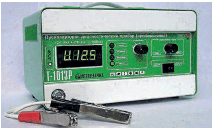
Импульсное пускозарядное устройство T-1013P, выпускаемое ЗАО «Автоэлектрика», может диагностировать стартеры и генераторы автомобилей, провести десульфатизацию, а также запустить двигатель, обеспечив пусковой ток силой в 100 А. Практически все ПЗУ, не имеющие встроенной собственной батареи, вырабатывают довольно низкий пусковой ток
