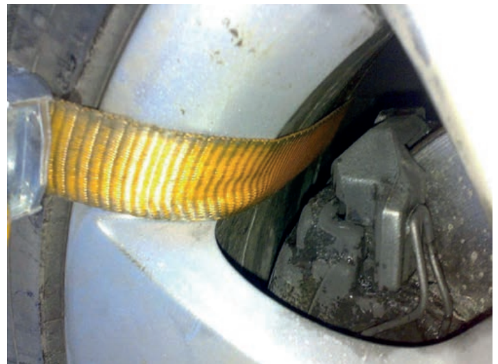
Браслеты противоскольжения легче надевать, когда колеса немного вывернуты в ту или иную сторону
