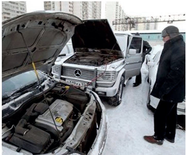
Запуститься, используя бортовую сеть другой машины, можно, но нужно строго соблюдать последовательность действий, иначе можно вывести из строя приборы электроники в обеих машинах
