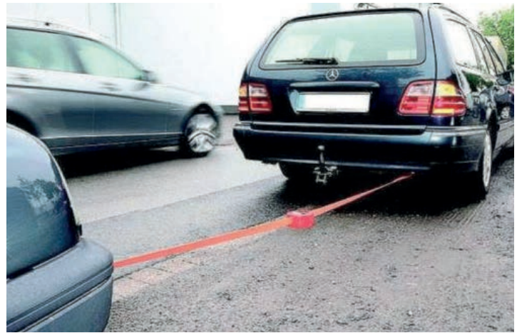
Метод буксирования при запуске двигателя эффективен разве что для карбюраторных двигателей
