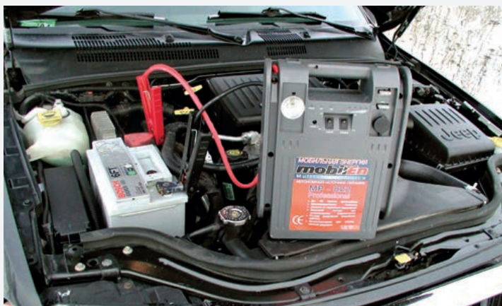
Если аккумулятор разряжен незначительно, то провода ПУ подсоединяют к соответствующим клеммам аккумулятора, устройство включается в пусковом режиме и стартером заводят двигатель
