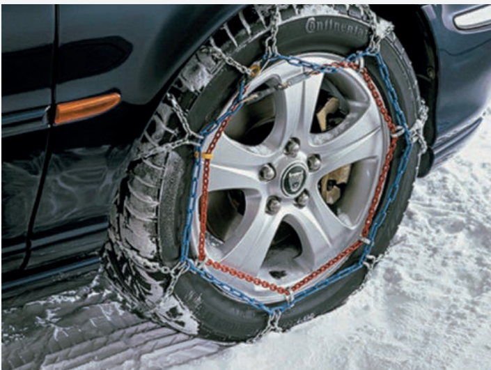
Для производства звеньев известные производители используют легированную сталь с добавками хрома, марганца и никеля, а в некоторых случаях и титана, что повышает эксплуатационный ресурс изделия
