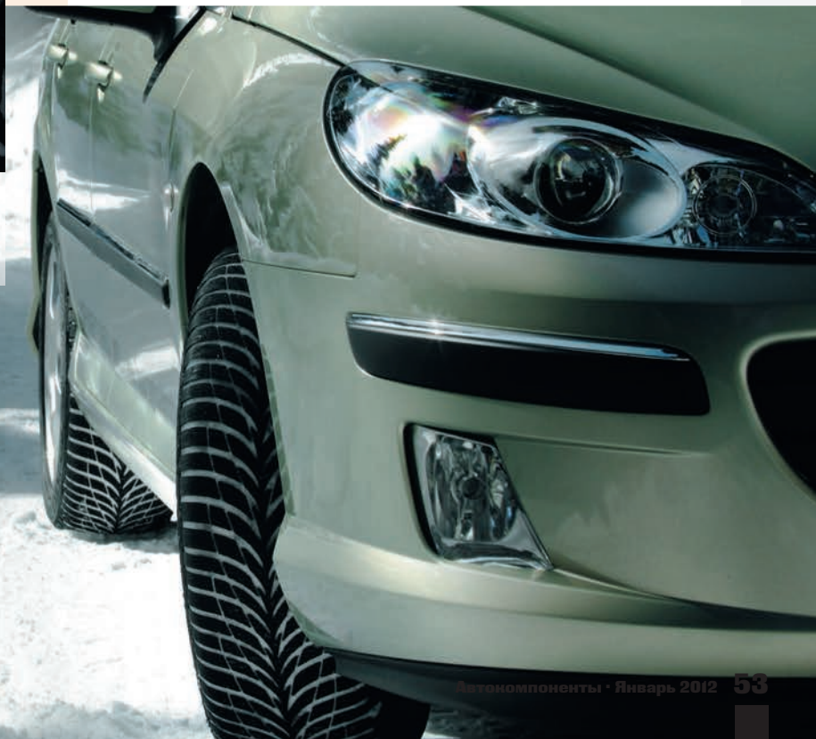
А зимние центральноевропейские шины — это менее агрессивный рисунок с меньшим количеством ламелей, скругленные плечевые зоны и более высокий индекс скорости
