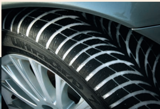
А зимние центральноевропейские шины — это менее агрессивный рисунок с меньшим количеством ламелей, скругленные плечевые зоны и более высокий индекс скорости
