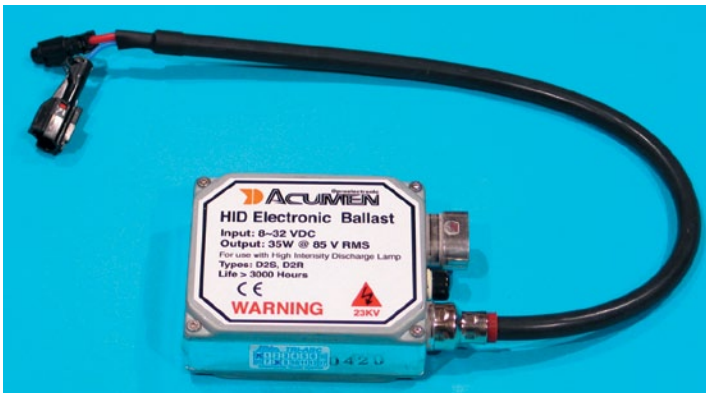
Провод идущий к лампе должен быть как можно короче
