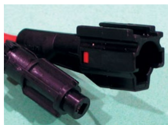
Разъемы лампы ксенонового света имеют герметичное исполнение
