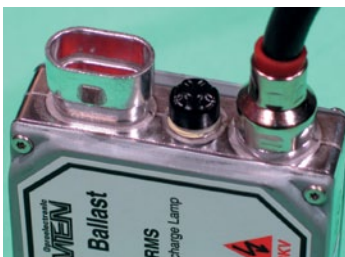
Некоторые блоки розжига имеют в корпусах сапуны
