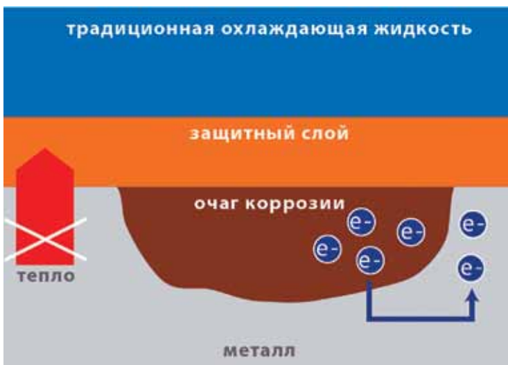
Слева показана защита металлических частей двигателя от коррозии традиционным антифризом (госолом), справа – карбоксилатным антифризом, не препятствующим теплоотводу с не подверженных коррозии поверхностей
