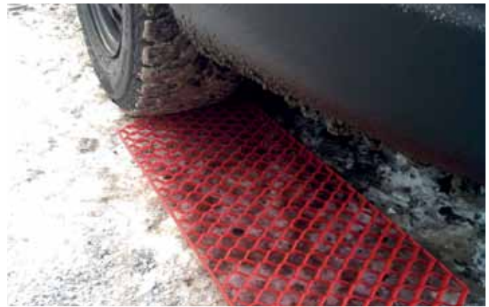
Коврики подкладывают только под ведущие колеса
