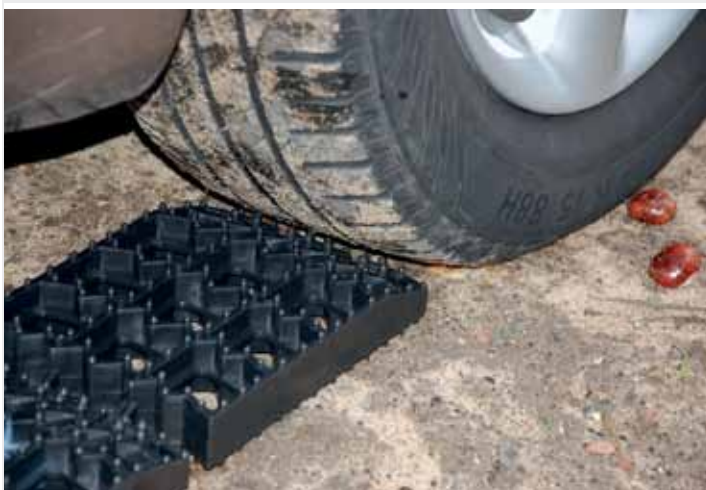
В трак можно монтировать любое количество отдельных звеньев
