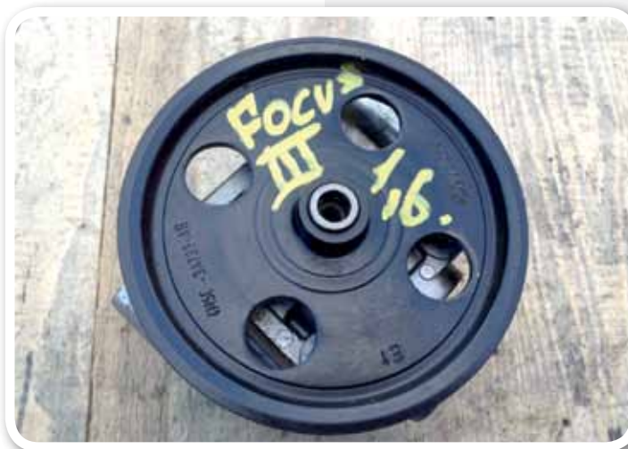
На восстановленные насосы ГУР требуется установка приводного шкива
