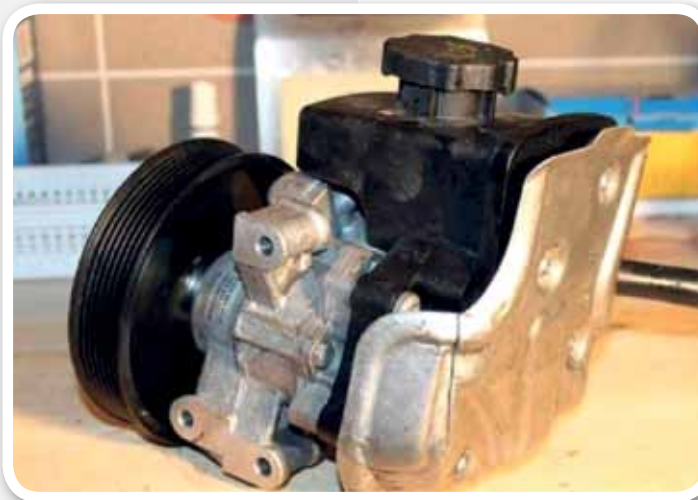
Насос ГУР Mercedes Benz W203(C180) с приводным шкивом
