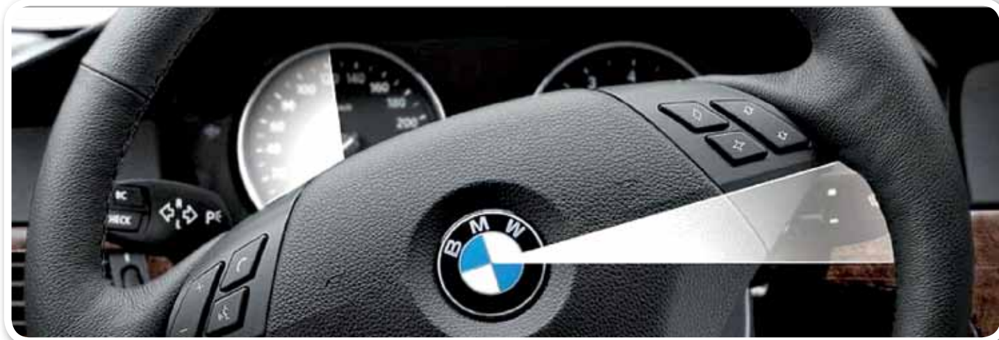
Максимально возможный люфт для рулевого колеса с наружным диаметром 400 мм не должен превышать 17 мм
