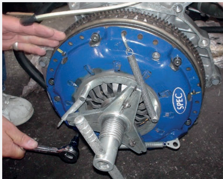
Без специальной оснастки сцепление SAC установить невозможно
