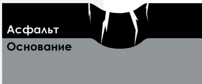
В конце концов покрытие обваливается в полость, формируя выбоину
