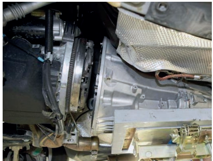
Отсоединение КП от двигателя
