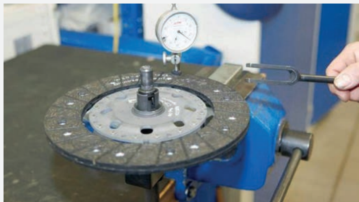
Проверка нового диска сцепления на биение
