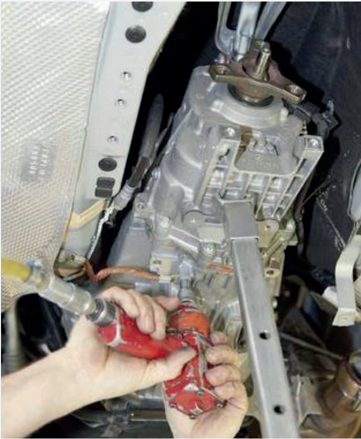
Отсоединение заземляющего провода от КП
