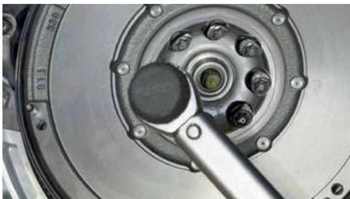
После затягивания болтов с моментом 50 Нм угломером нужно их довернуть на 90°
