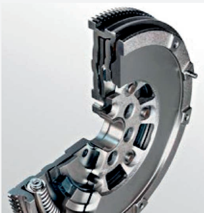
При замене сцепления может понадобиться и замена маховика. Двухмассовый маховик от компании LuK
