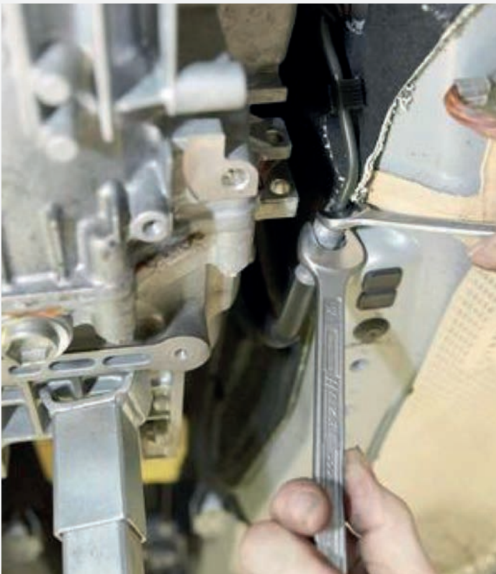
Рассоединение гибкого и металлического трубопроводов, подводящих рабочую жидкость к гидравлическому выжимному подшипнику
