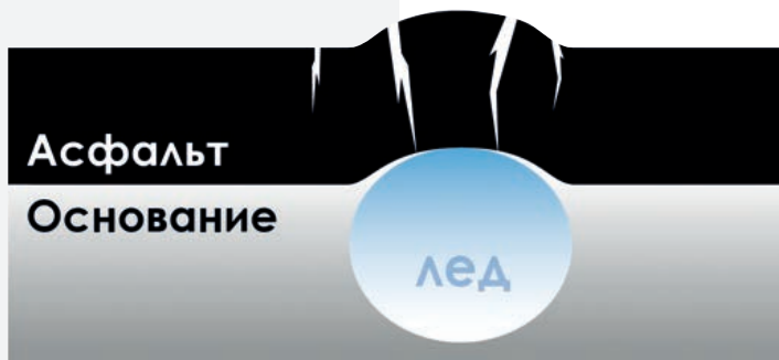
Вода замерзает, расширяется и выталкивает асфальт вверх
