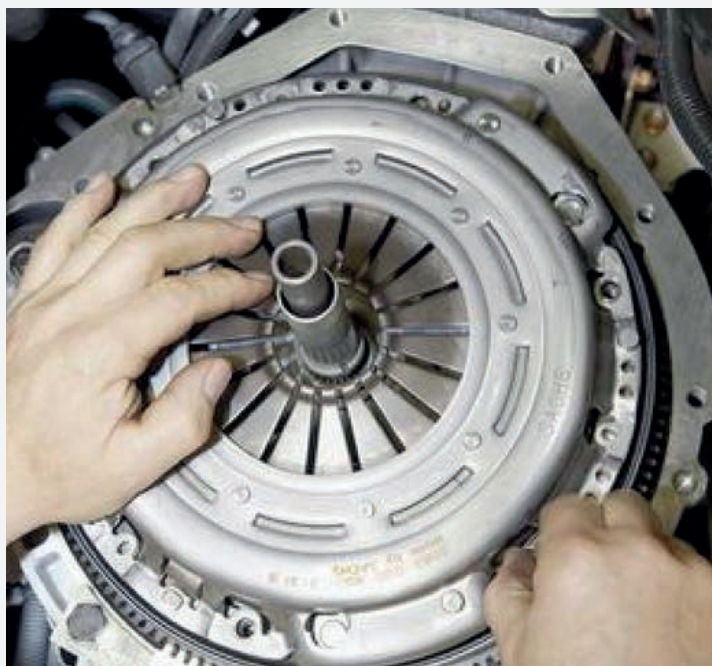
Закрепляем корзину сцепления
