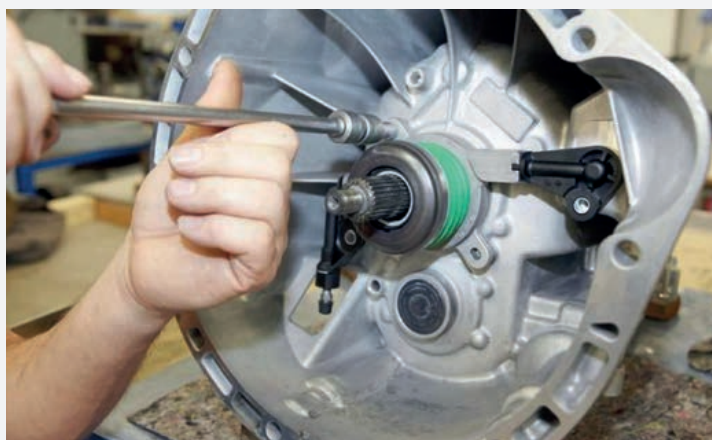
При замене сцепления рекомендуется заменить выжимной подшипник
