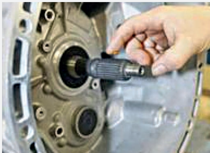
Смазывание шлицов первичного вала КП
