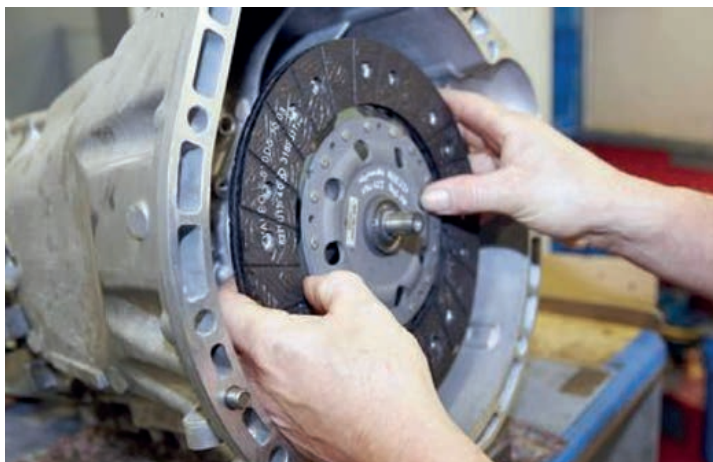
Надеваем на шлицы диск сцепления и удаляем лишнюю смазку
