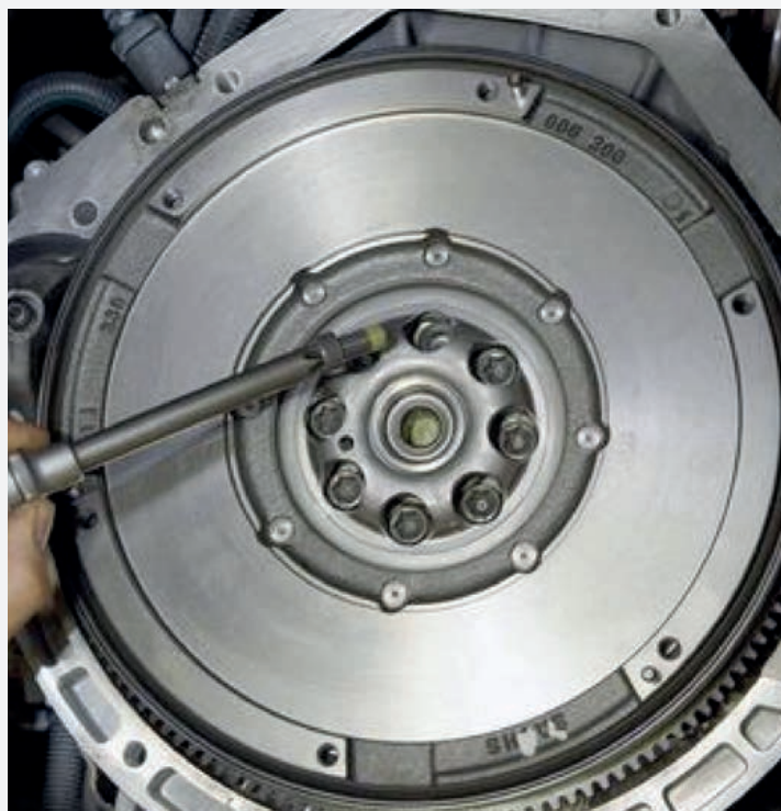
Крепление двухмассового маховика к коленвалу должно быть очень тщательным
