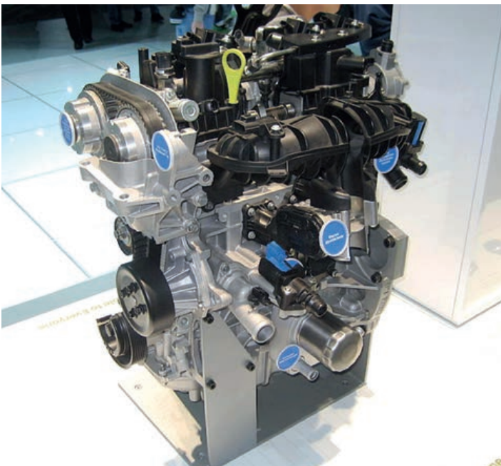
В уникальном 3-цилиндровом двигателе Ford 1,0 EcoBoost использован зубчатый ремень, который по заявлениям производителей рассчитан на 240 тыс. км пробега или 10 лет эксплуатации
