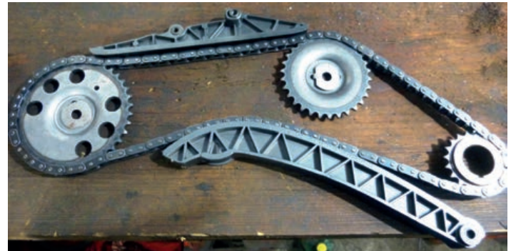
Однорядные цепи гораздо компактнее двухрядных, но «выхаживают» значительно меньше
