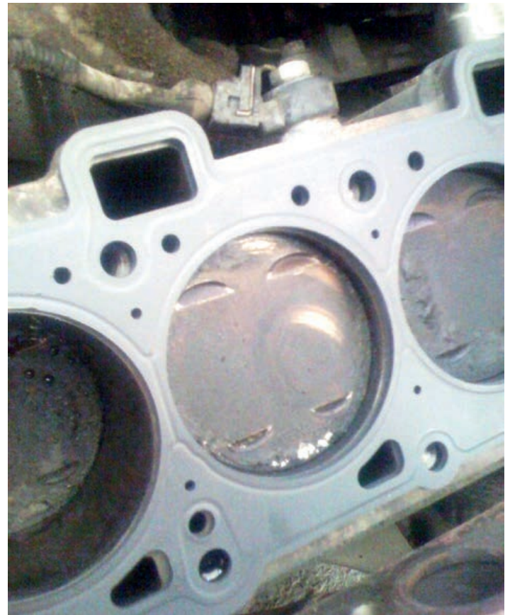
Последствия обрыва ремня в «Ладе Приоре» – клапаны встретились с поршнями
