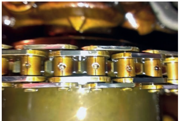
Цепь, находясь внутри двигателя, постоянно смазывается и полностью защищена от любых внешних воздействий. Ни погодные условия, ни повышенная запыленность или влажность на работу цепи повлиять не могут
