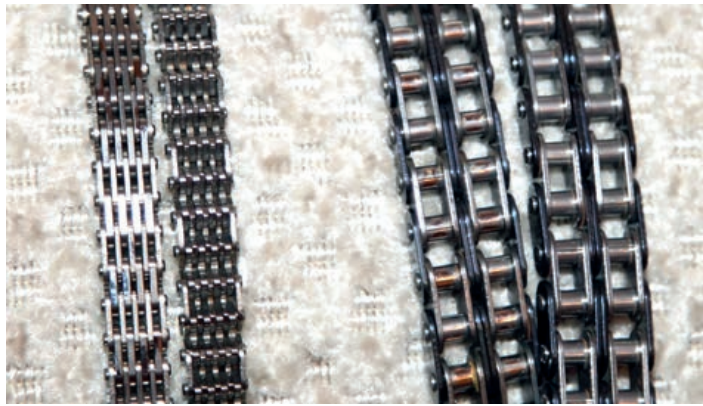
В Skoda Octavia в приводе ГРМ зубчатые цепи решили заменить на более легкие двухрядные втулочно-роликовые
