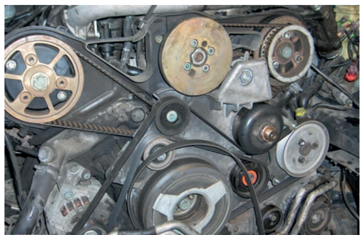
Audi A6 2.5 TDI - в конструкции двигателя используется целый набор ремней и роликов
