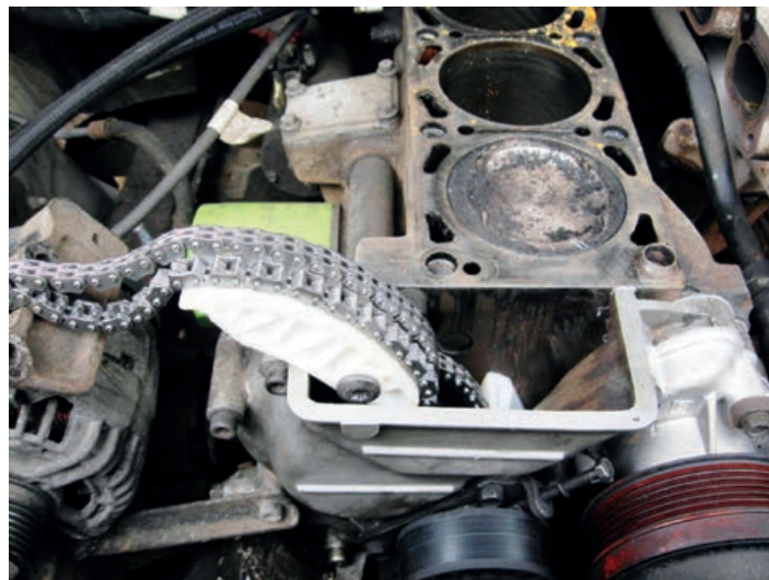
В двигателях семейства 3М3-409 после 2012 года в некоторых модификациях двигателей в приводе распредвалов начали использовать зубчатые цепи вместо применявшихся ранее двухрядных...
