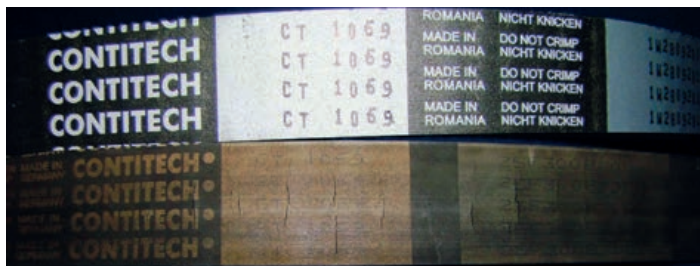
Лучше приобретать приводные ремни ContiTech «родом» из Германии. водители утверждают, что качество румынских или мексиканских ContiTech значительно ниже. Нижний ремень прошел около 50 тыс. км
