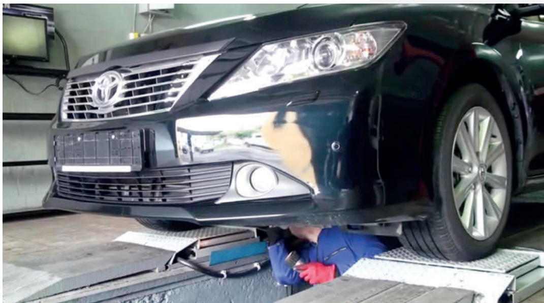
Проверка ступичного подшипника на люфт-детекторе Ravaglioli R 200/8 – быстро, качественно, удобно
