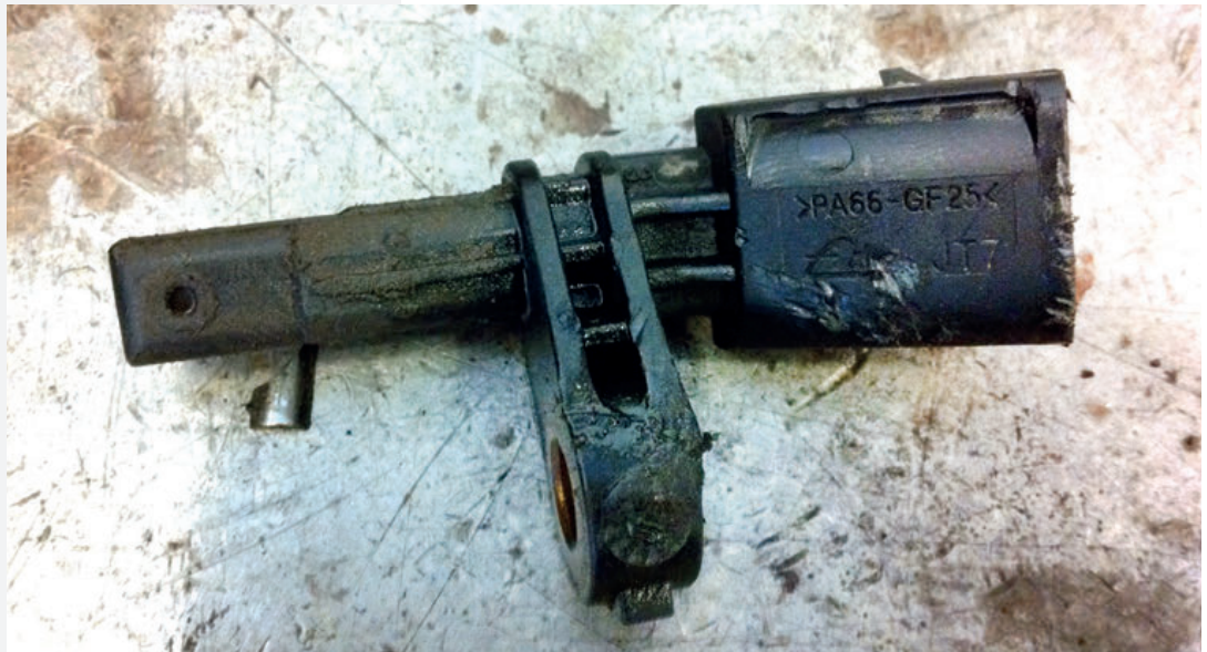
При замене ступичного подшипника датчик ABS легко можно повредить, он пластиковый и хрупкий
