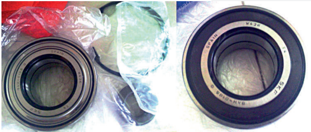
Большинство ступичных подшипников имеют магнитное кольцо, необходимое для действенной работы системы ABS, оно – с одной стороны подшипника, а с другой – обычная стальная крышка
