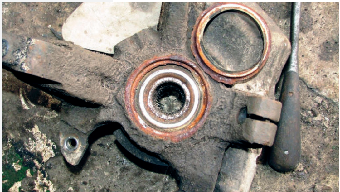
Осмотрев вышедший из строя подшипник, можно определить причину поломки. На фото – ржавчина говорит о присутствии воды, которая и является «виновницей»
