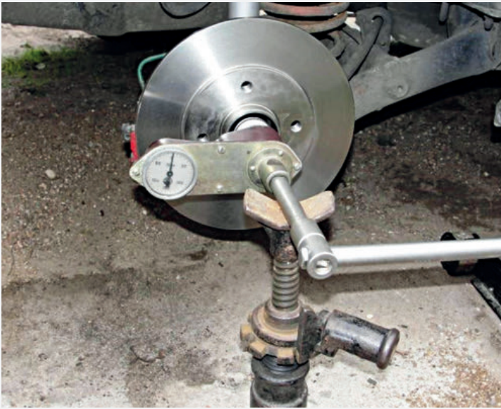
Гайка, поднимающая ступичный подшипник, закручивается с определенным усилием, поэтому необходимо использовать динамометрический ключ
