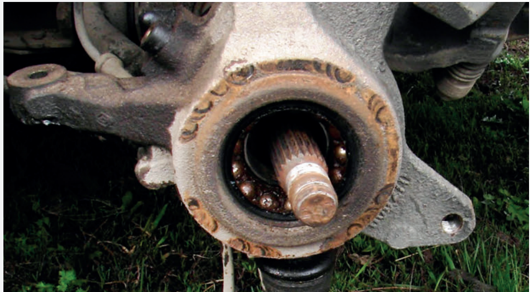
При появлении гула нужно оперативно принимать меры – подшипник может «рассыпаться» буквально через 150–250 км
