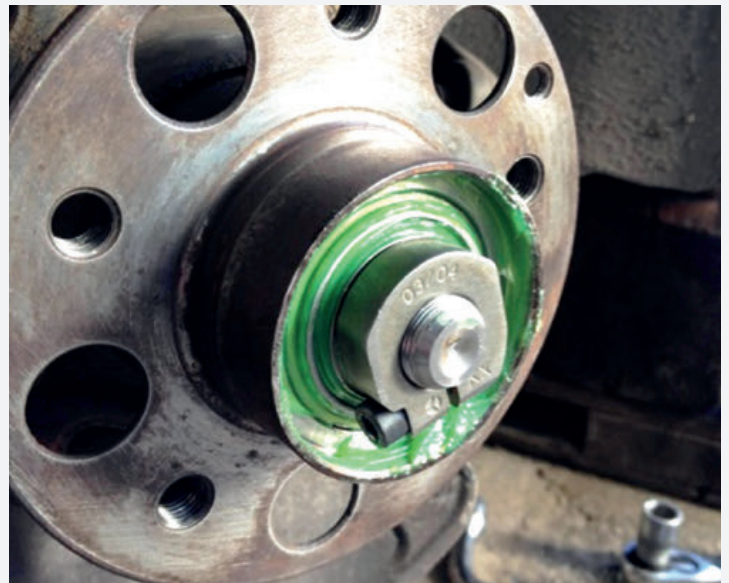
Ступичные подшипники на МВ смазываются оригинальной смазкой. С отсутствием смазки связано 70% поломок ступичных подшипников
