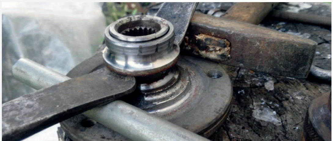
Часто после демонтажа развалившегося подшипника на оси ступицы остается его внутренняя обойма. Снимать ее нужно аккуратно, чтобы не повредить ступицу
