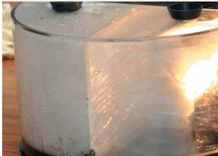
Последствия попадания влаги на разные лампы. Лампа Philips установлена в правую часть установки
