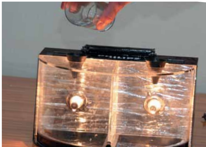
Последствия попадания влаги на разные лампы. Лампа Philips установлена в правую часть установки
