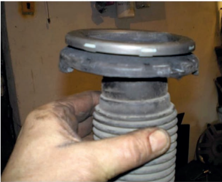
Очень важным является состояние пыльников. От них во многом зависит продолжительность жизни амортизатора
