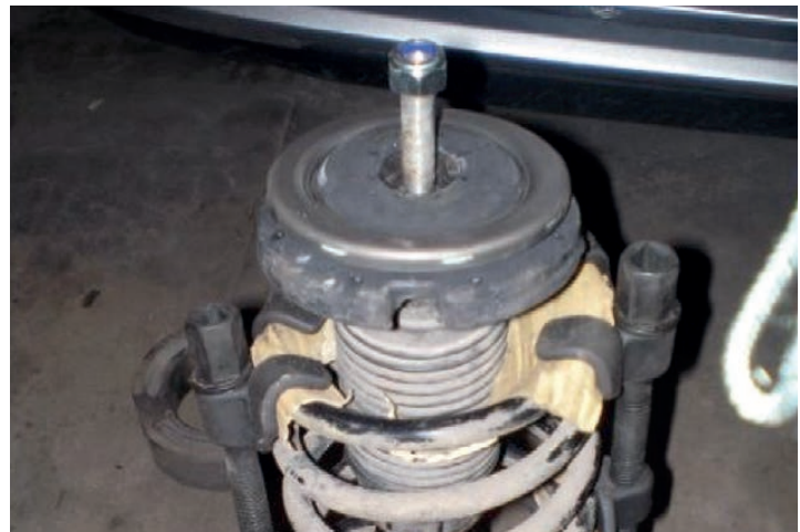
Достаточно опасная операция с передней стойкой – специальными захватами сжимаем пружину для демонтажа переднего амортизатора
