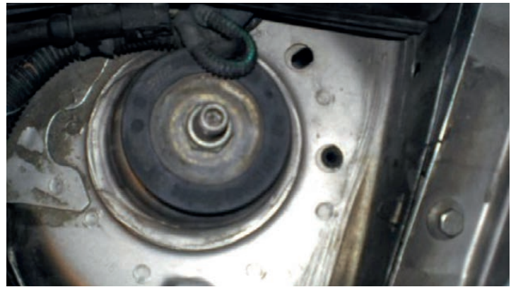
Верхнюю опору передней амортизаторной стойки фиксирует гайна, с нее начинается демонтаж. Положение чашки и уплотнений не меняем до сборки
