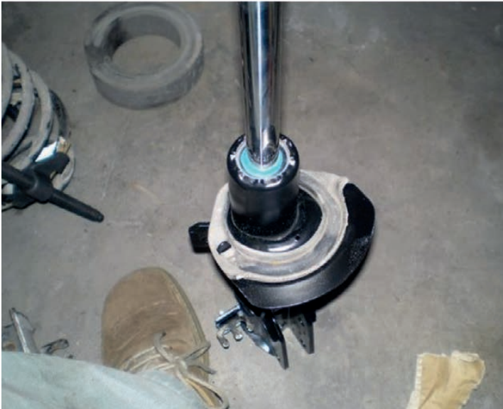
После удаления воздуха путем прокачки передний амортизатор до установки на машину должен находиться в положении штоком вверх
