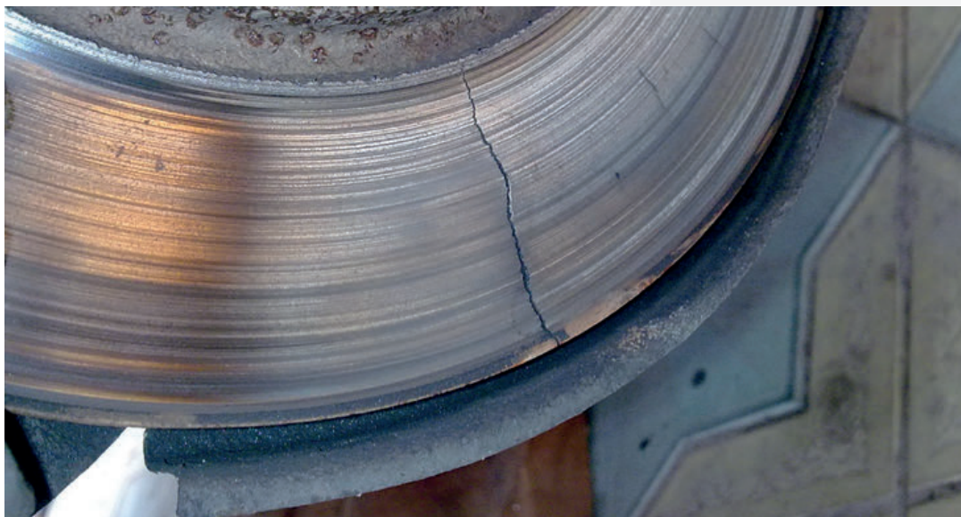
Тонкий тормозной диск плохо рассеивает тепло и может при интенсивном торможении треснуть
