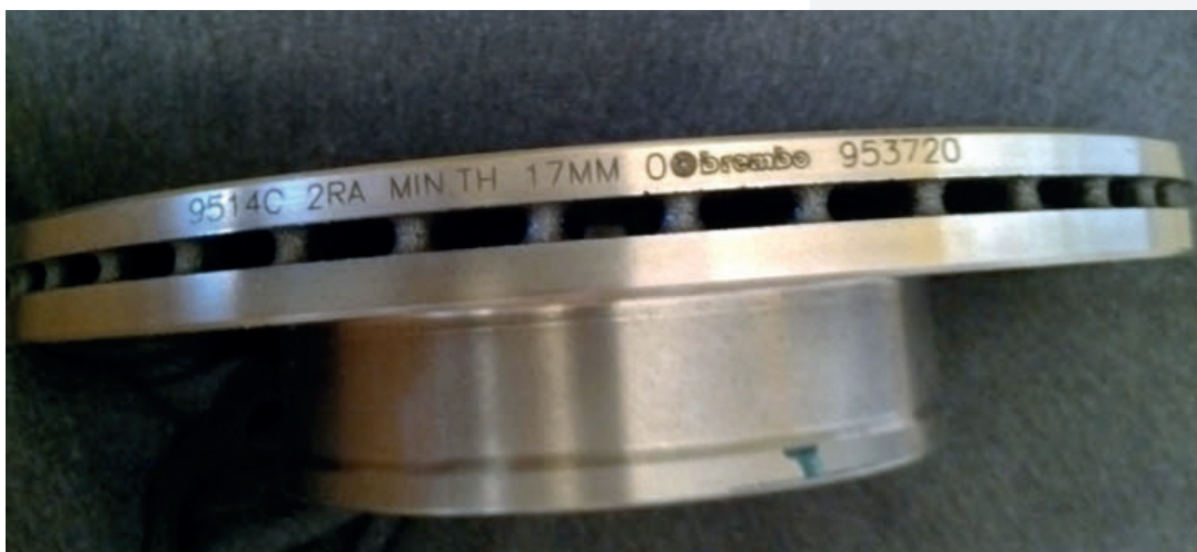
На многих дисках на торце указывается минимально допустимая толщина, при достижении которой диск необходимо срочно заменить на новый
