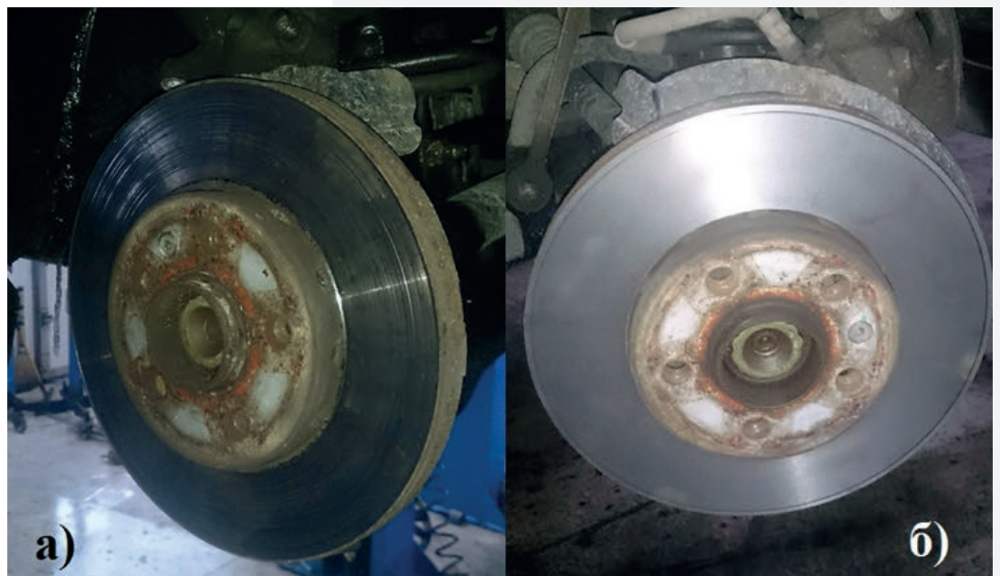
Один и тот же тормозной диск: а) с канавками на рабочей плоскости; б) после механической обработки
