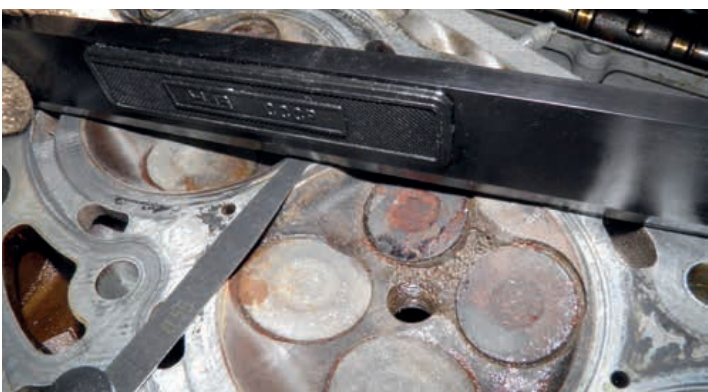
Типичный признак перегрева двигателя в начальной стадии - деформация плоскости ГБЦ
