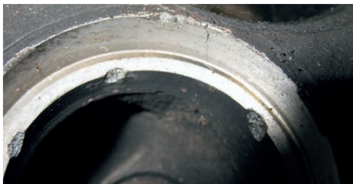
Трещина в ГБЦ - одна из возможных причин повышенного давления в системе охлаждения
