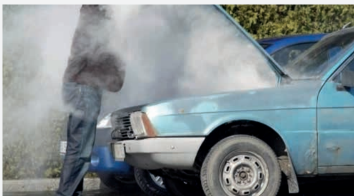
Вытекание охлаждающей жидкости провоцирует перегрев - одну из самых распространенных причин выхода двигателя из строя
