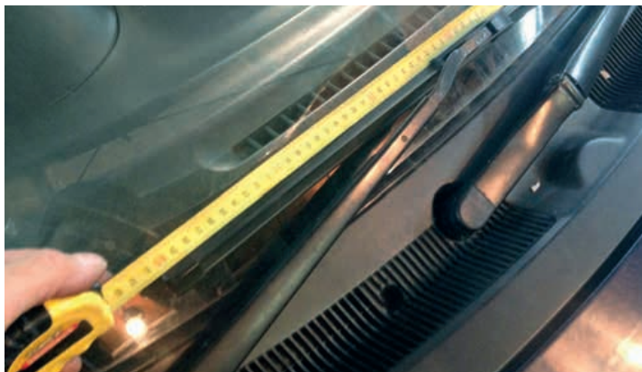
Перед приобретением новых стеклоочистителей желательно измерить длину резиновых накладок
