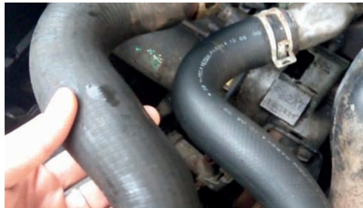
Повышенное давление в системе охлаждения может очень заметно увеличить патрубки в диаметре
