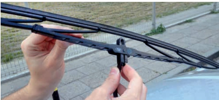
Замена дворников обычно проблем не вызывает. Только важно помнить, что подпружиненный поводок, если его неосторожно толкнуть, может не только поцарапать лобовое стекло, но и образовать в стекле трещину
