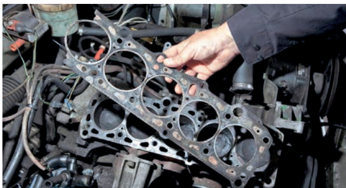
Одно из последствий перегрева - прогоревшая прокладка ГБЦ
