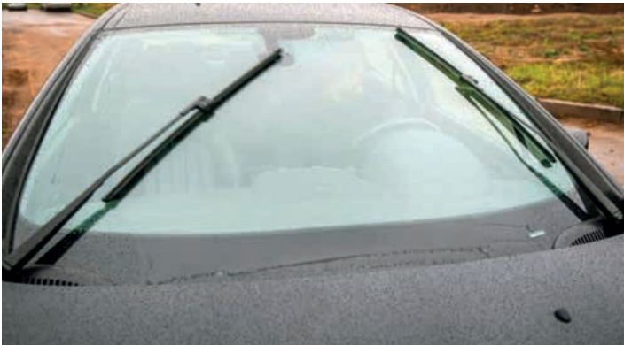
Распашная схема работы дворников становится сегодня популярной, особенно в автомобилях, в которых высота лобового стекла равна или даже превышает его ширину. Распашные дворники в Peugeot 307
