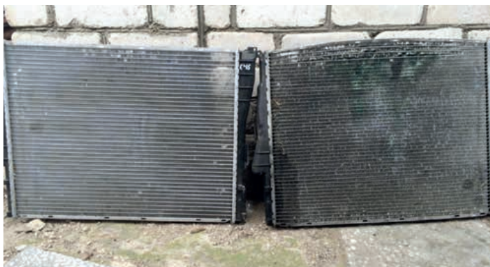
Раздутый радиатор (справа) – верный признак превышения положенного давления в системе охлаждения. С таким дефектом радиатор подлечит обязательной замене
