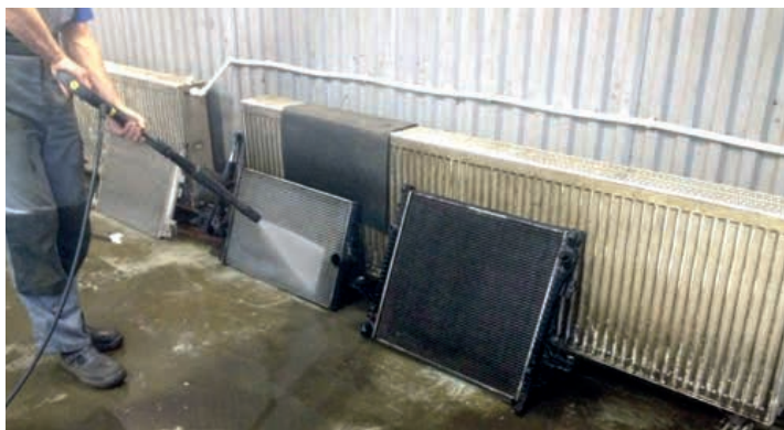
Промыть радиатор струей воды – это доступно любому водителю
