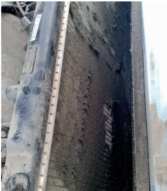
Если отпустить верхние крепления и отвести основной радиатор от радиатора кондиционера, то становится ясно, почему часто включается вентилятор в системе охлаждения
