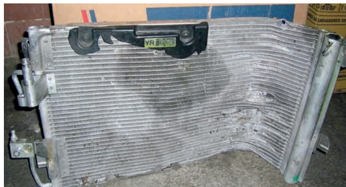
Даже незначительное столкновение автомобилей может привести к серьезному, порой окончательному выходу из строя радиатора системы охлаждения
