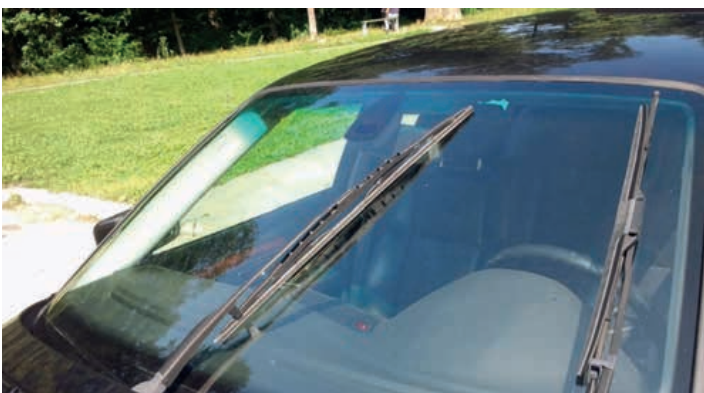
Для замены дворников рычаги-поводки лучше установить в вертикальном, сервисном, положении
