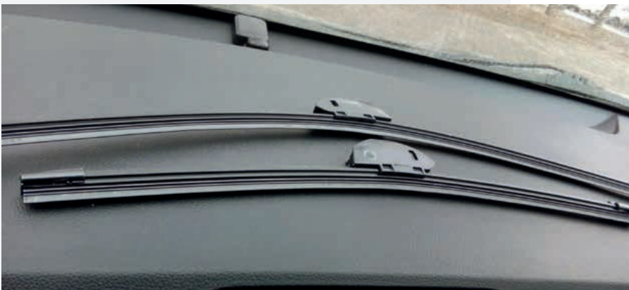
Бескарнасные дворники равномерно, по всей длине резиновой накладки, прижимают ее к лобовому стеклу
