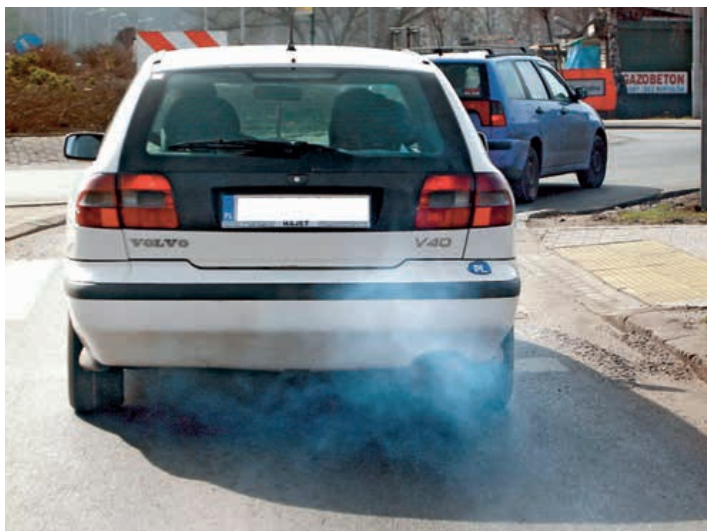
Белый дым из выхлопной трубы появляется, если после перегрева сгорит прокладка ГБЦ и в цилиндры начинает попадать ОЖ
