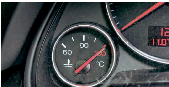
Рабочая температура ОЖ составляет 85-95°C. Допускается кратковременное, не более чем на 5 минут, повышение температуры до 100-105°C
