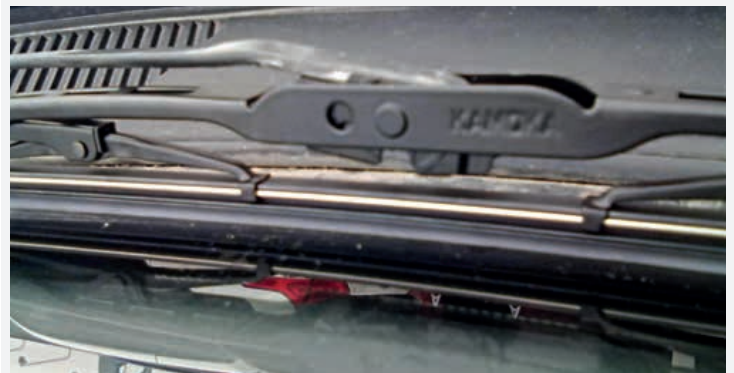
Металлическая каркасная конструкция дворника с несколькими «качелями», необходимыми для прижима накладки к стеклу, на стеклах большого размера отрицательно сказывается и на надежности стеклоочистителей, и на аэродинамике автомобиля
