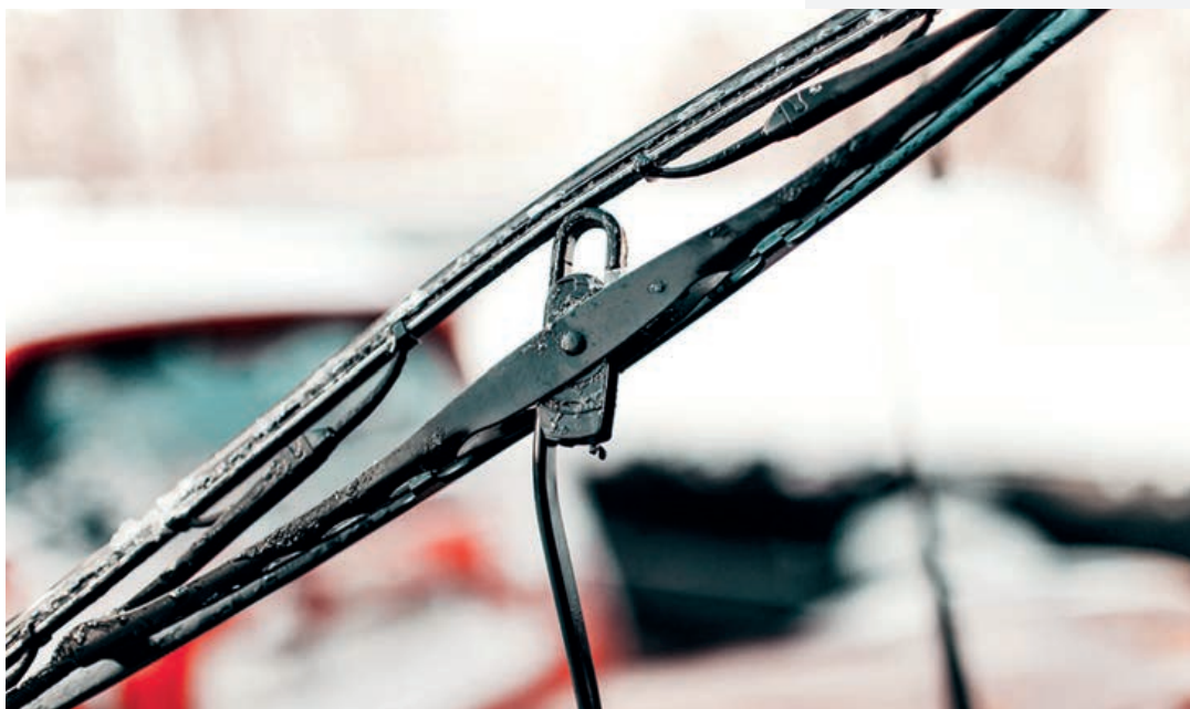
Пример того, как выглядит «замученная» жизнью щетка стеклоочистителя. Лучше менять «дворники» вовремя
