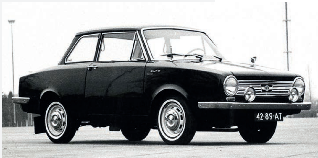
BMW Glas 1004 1962 года стал первым массовым авто с ремнем в приводе ГРМ.
