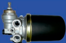
РЕГУЛЯТОР ДАВЛЕНИЯ С АДСОРБЕРОМ (8043.35.12.010)
