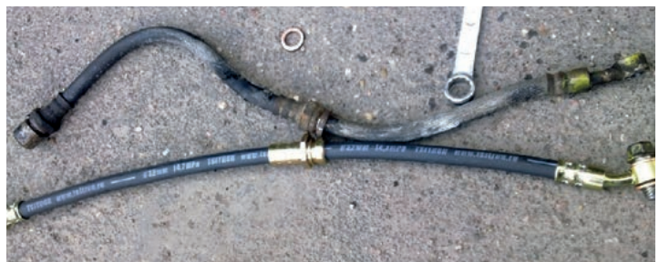
На гибком шланге для контроля перенручивания нанесена боковая линия, а также все основные характеристики самого шланга. Медные уплотнительные шайбы подлежат замене. Спецболт, если он сильно корродирован, тоже лучше заменить
