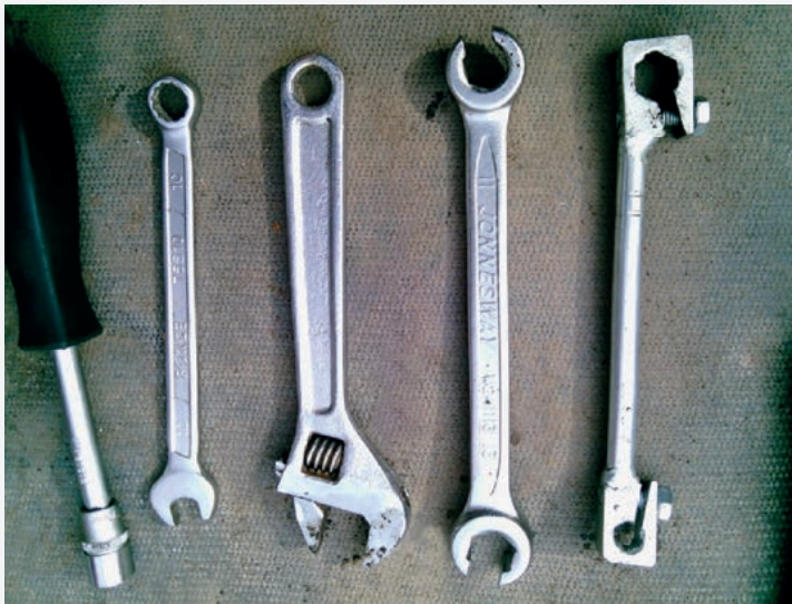
Для замены шлангов может потребоваться такой набор ключей, в т.ч. и специальных
