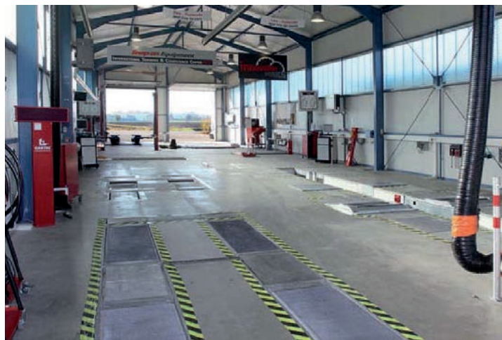
Для комплексного диагностирования систем автомобиля: измерения тормозной силы, статической нагрузки на ось машины, бокового увода колеса и усилий, прикладываемых к органам управления, – компанией Cartec на базе стенов BDE создан целый ряд линий серии BDE
