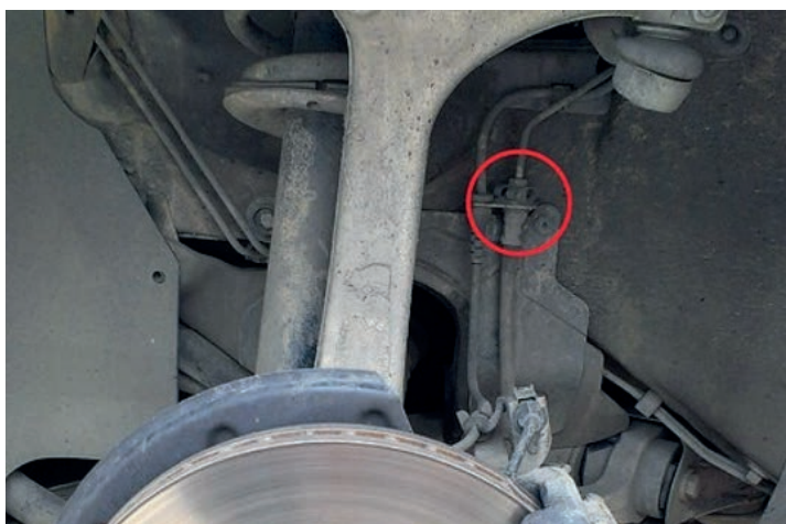
Снимаем колесо и обрабатываем жидкостью WD40 соединение гибкого шланга с жесткой тормозной трубной...
