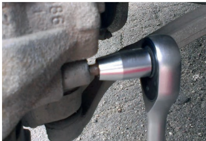
Откручиваем два болта крепления суппорта шестигранником на 7. С помощью молотка и ного-либо рычага суппорт стягивается, иначе не доберетесь до соединения гибкого шланга
