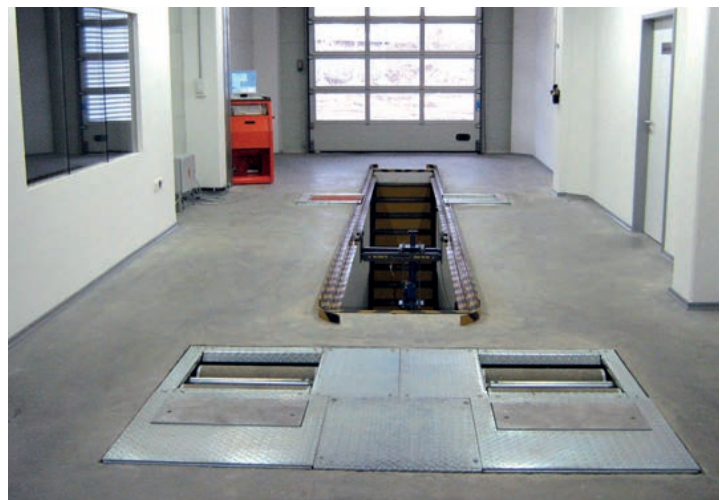
Для установки диагностических роликовых стендов требуется гораздо меньше места по сравнению с платформенными стендами. Принцип действия роликовых стендов заключается в моделировании дорожного движения за счет принудительного прокручивания колес машины вращающимися роликами
