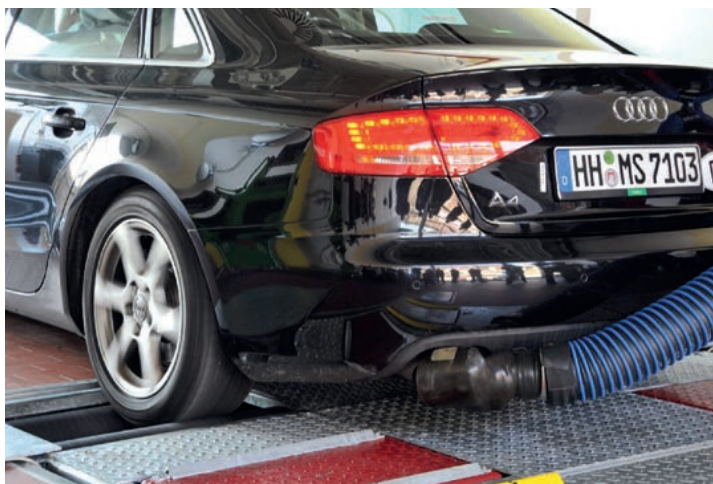
Диагностические комплексы Cartec состоят из отдельных автономных устройств, вмонтированных в пол и располагающихся последовательно по маршруту перемещения автомобиля в боксе автосервиса
