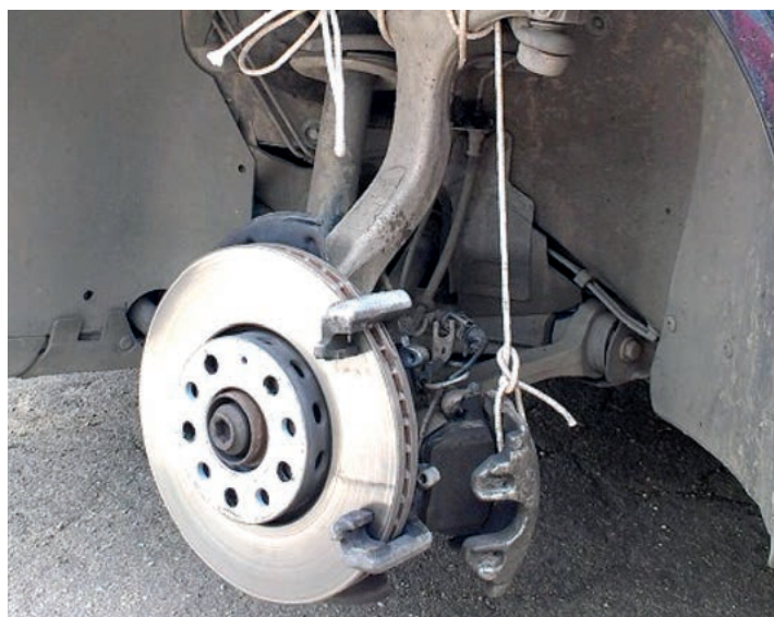
Части суппорта можно просто временно повесить, привязав веревкой
