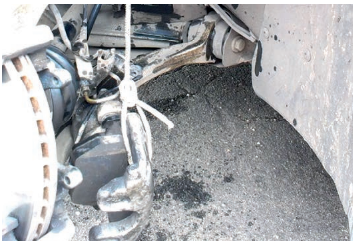
Новый шланг устанавливается в обратном порядке
