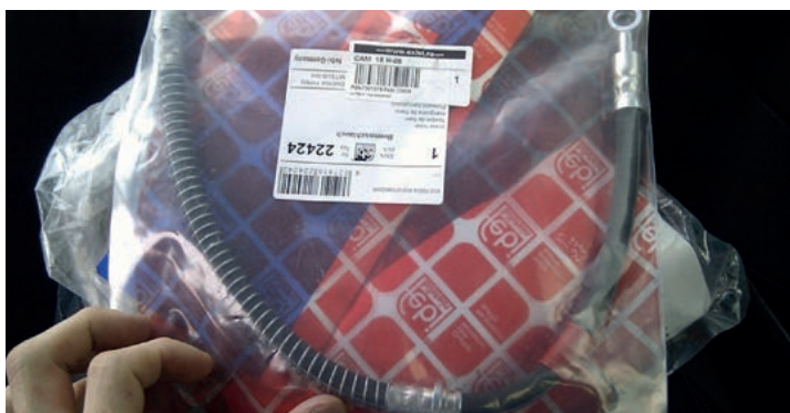
Гибкий тормозной шланг на Volvo S80 II 2,5T
