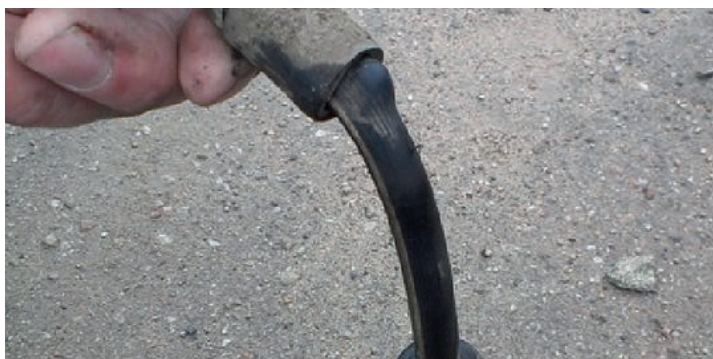
На шлангах плохого качества возможны увеличения сечения, влияющие на снижение тормозного усилия
