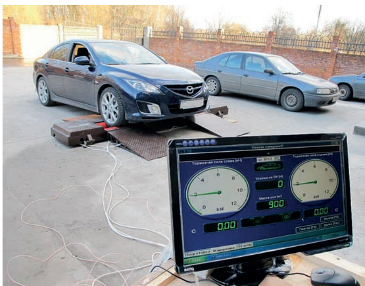
Компактный мобильный роликовый стенд СТМ-3500МН не уступает по качеству импортному оборудованию
