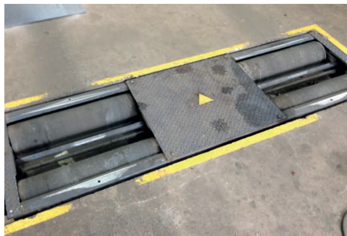
На ролики тормозных стенов Bosch BSA 43xx наносится специальное износостойкое покрытие на основе корунда
