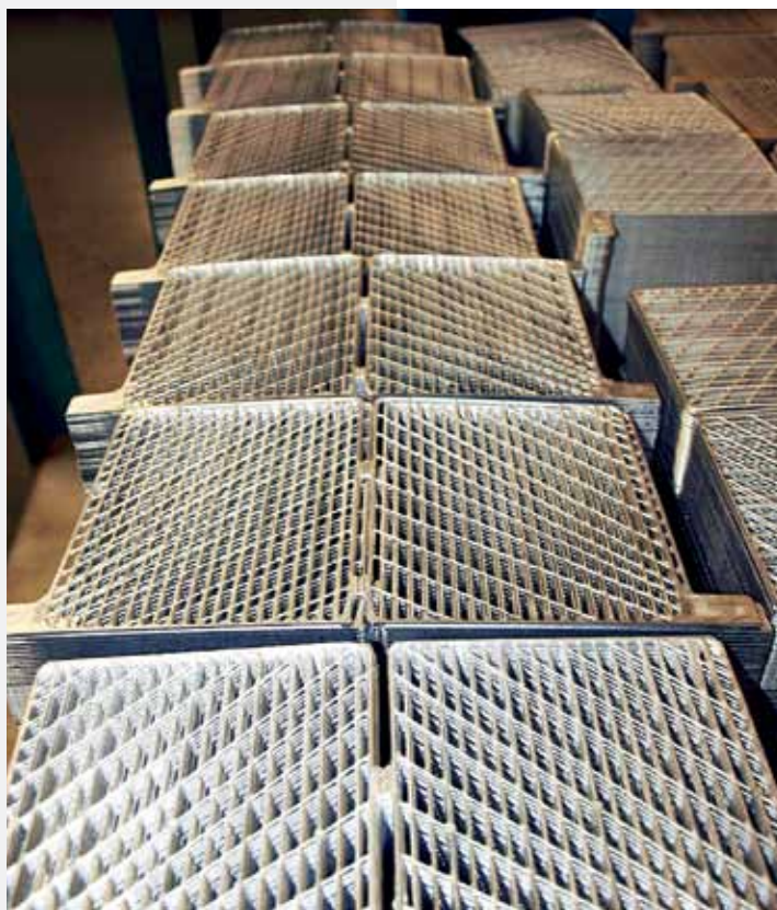
Готовые решетки PowerFrame ждут установки на аккумуляторы
