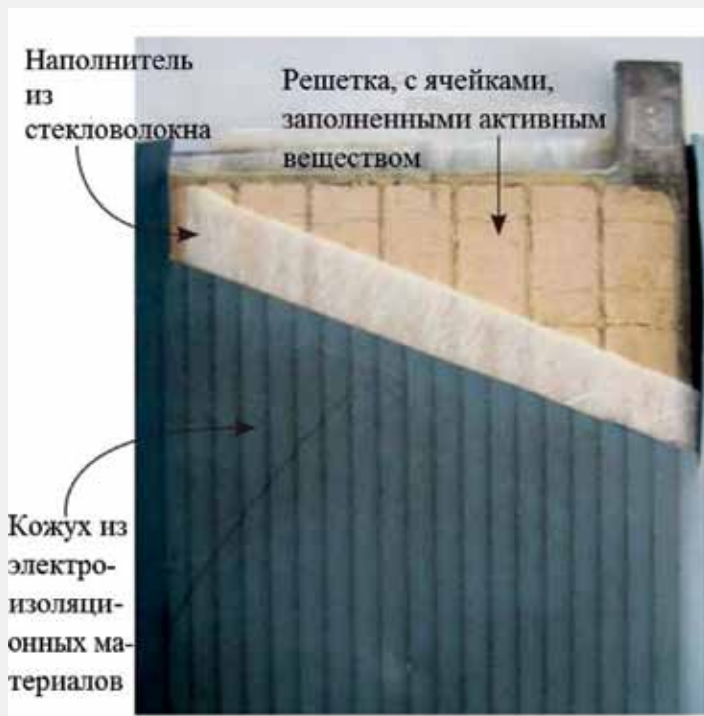
В пластине AGM-аккумулятора основной элемент – решетка, ячейки которой заполнены активным веществом
