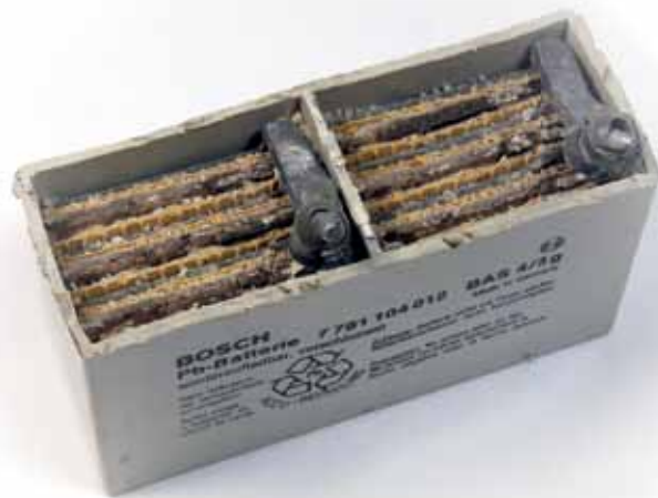
Аккумулятор AGM в разрезе: отсутствие электролита в жидком виде позволяет избежать разливов кислоты при изменении пространственного положения АКБ
