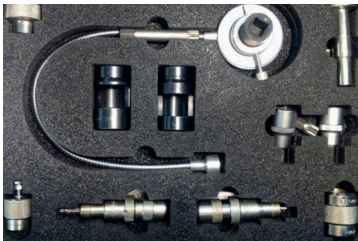
Для того чтобы форсунку разобрать, потребуется специальный инструмент
