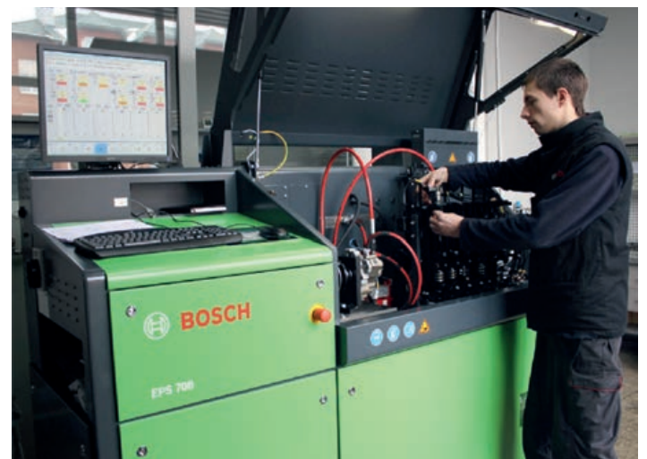
Диагностический стенд с компьютерным управлением Bosch EPS 815 предназначен для тестирования ТНВД традиционных типов H, R, A, M, MW, P, VE. Если стенд дооснастить комплектom оборудования Bosch VPM 844, то EPS 815 сможет тестировать ТНВД с электромагнитным контролем процесса впрыска типа VP29, VP30, VP44. Только компания Bosch производит подобное оборудование для диагностики ТНВД
