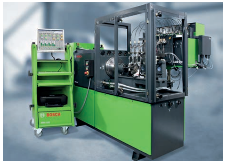
Диагностический стенд с компьютерным управлением Bosch EPS 815 предназначен для тестирования ТНВД традиционных типов H, R, A, M, MW, P, VE. Если стенд дооснастить комплектom оборудования Bosch VPM 844, то EPS 815 сможет тестировать ТНВД с электромагнитным контролем процесса впрыска типа VP29, VP30, VP44. Только компания Bosch производит подобное оборудование для диагностики ТНВД
