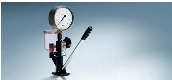
Специально для проверки и регулировки давления открытия форсунок компания Bosch предлагает ручной прибор EPS 100. Точнейший прибор с манометром класса 0,6, у которого погрешность измерений не превышает \pm 2,4 бар, позволяет производить анализ формы и распыленности струи топлива, подаваемого форсункой, определять наличие утечки в распылителях
