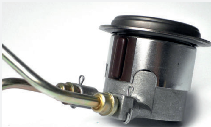
Гидравлические выжимные подшипники постепенно вытесняют традиционные. Корпус выжимного подшипника узла сцепления автомобилей Rover 75 и MG ZTT изготовлен из алюминия, верхняя крышка стальная, ресурс – не менее 150 тыс. км пробега
