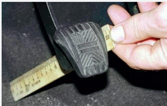
Положение педали сцепления настраивается: свободный ход составляет 15...25 мм от крайнего верхнего положения до положения, когда выжимной подшипник начинает давить на демпферную пружину. От накладки педали до пола расстояние должно быть 160 \pm 2 мм
