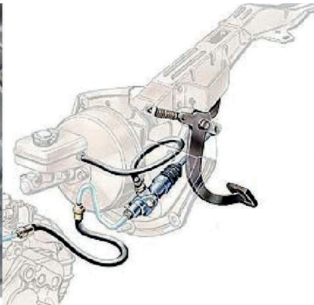
Большая часть автопроизводителей используют в конструкциях выжимных подшипников гидравлику, где выжимные вилки отсутствуют
