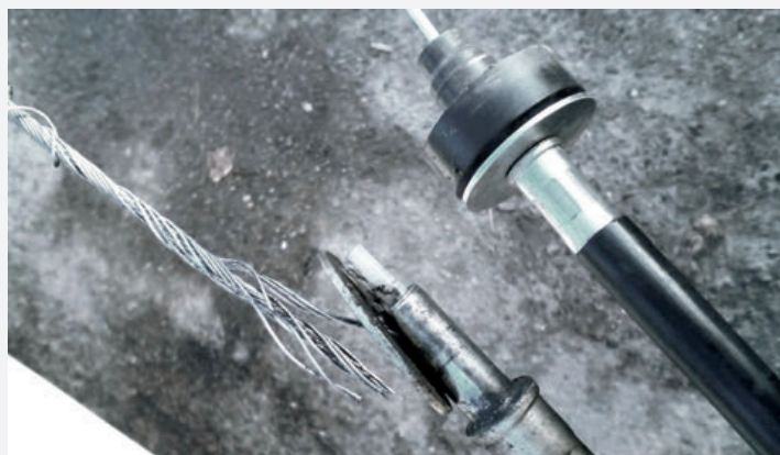
Обрыв троса – наиболее частая причина «падения» педали сцепления при использовании механического привода в системе сцепления
