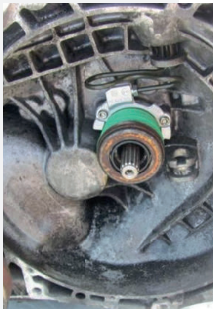
Большая часть автопроизводителей используют в конструкциях выжимных подшипников гидравлику, где выжимные вилки отсутствуют
