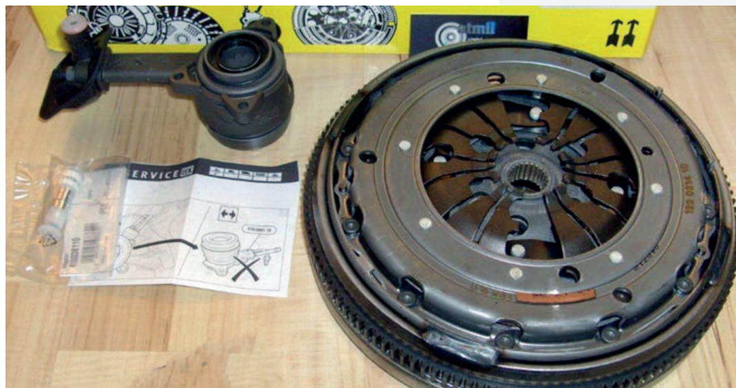
Двухмассовый маховик в конструкциях сцепления появился именно с целью эффективного гашения генерируемых двигателем колебаний, которые передаются через КПП. Двухмассовое сцепление производства компании LUK для моделей VW Sharan, Ford Galaxy, Seat Alhambra
