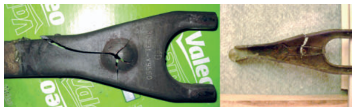
Поломна выжимной вилки – распространенная причина выхода сцепления из строя
