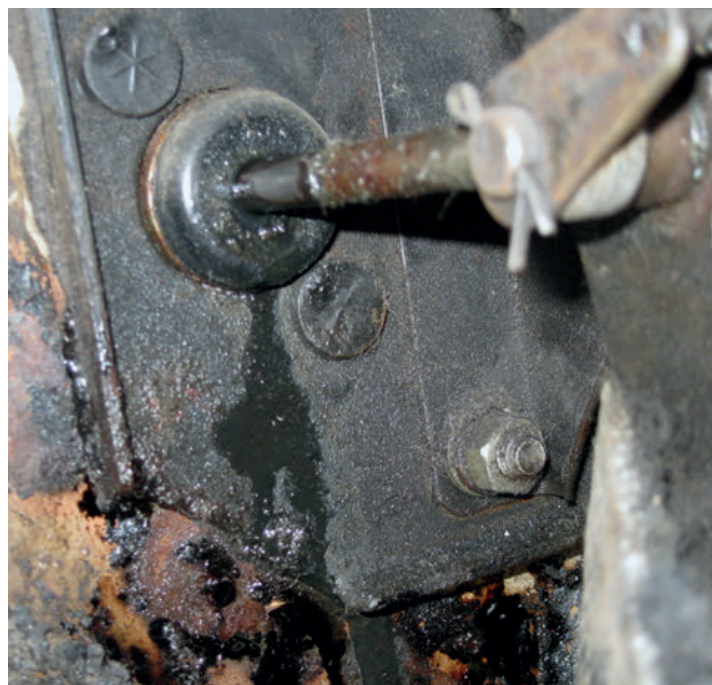
В сцеплении с гидроприводом при «падении» педали прежде всего проверяют, нет ли течей тормозной жидкости, например, из главного цилиндра сцепления
