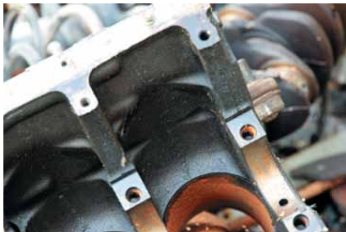
На внутренней поверхности блока цилиндров смолистые и лаковые отложения накапливаются быстро, особенно при применении минеральных масел устаревших классов качества, и держатся очень стойко. Смыть такие даже промывочным маслом бывает крайне сложно.
