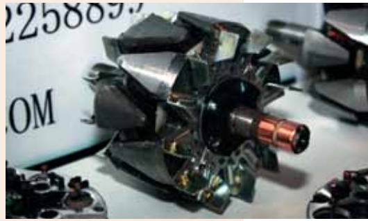
Альтернативный ротор генератора должен быть отбалансирован не хуже «родного».
