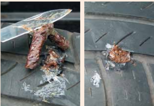
Отрезаем жгут острым ножом заподлицо с протектором, накачиваем колесо и проверяем его на герметичность!
