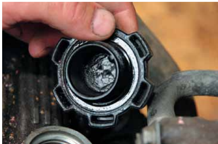
Пример безобразного отношения к машине – на внутренней поверхности крышки маслозаливной горловины мотора автомобиля Toyota густые мажеобразные отложения. Такой же гуталин и под клапанной крышкой. Промывочное масло может привести к тому, что грязь отслоится от деталей мотора и забьет маслоприемник. А это уже чревато масляным голоданием мотора.
