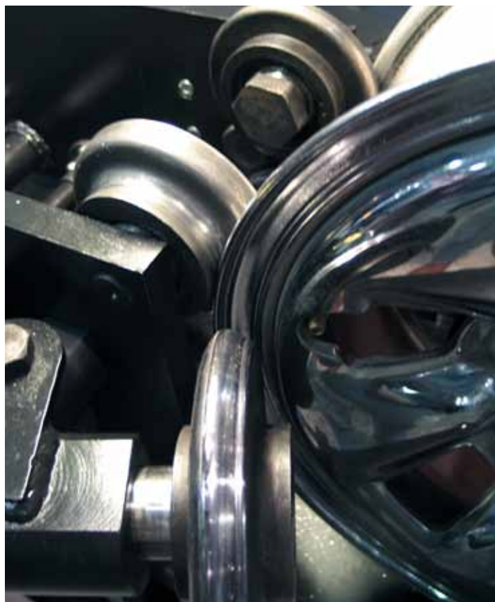
Небрежное раскатывание закран дисков, имеющих полированную поверхность, заканчивается образованием микротрещин.
