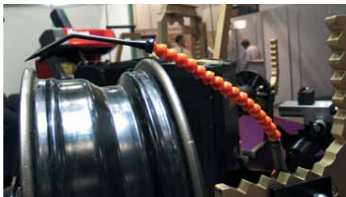
Такие нехитрые приспособления позволяют визуально определить биение колеса, для чего его нужно просто раскрутить на стенде.
