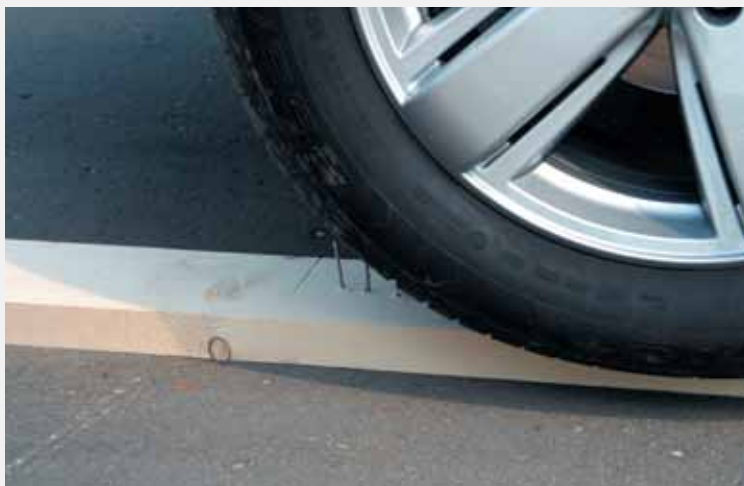
Если под шиной герметик, то можно и по гвоздям...
