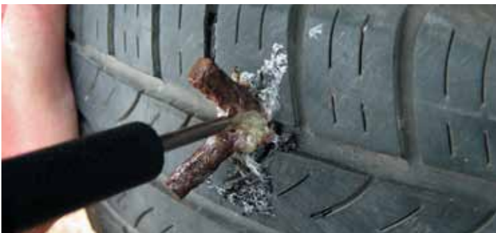
Важно утопить жгут так, чтобы его петля обязательно вышла с обратной стороны полкрышки.
