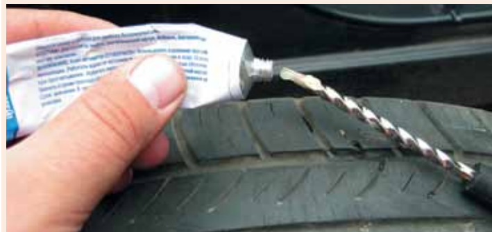
Разработанное шилом отверстие обязательно смазываем прилагаемым в наборе активатором.
