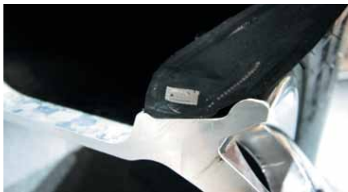
Наглядный пример того, где происходит контакт диска и шины (бескамерное колесо). Теперь понятно почему закраину можно ремонтировать?
