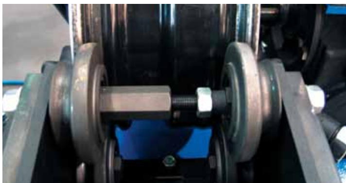
Оптимальный вариант прокатки ручьев – синхронный. Расстояние между роликами регулируется распорным винтом.
