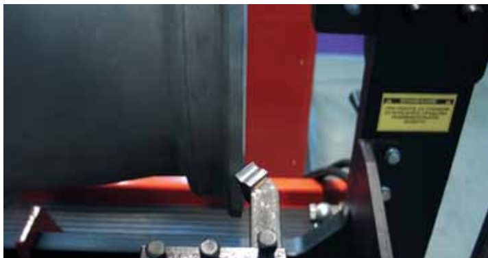
Важная, финишная операция ремонта диска, у которого правилаась или варилась закраина обода – срезание излишек металла.
