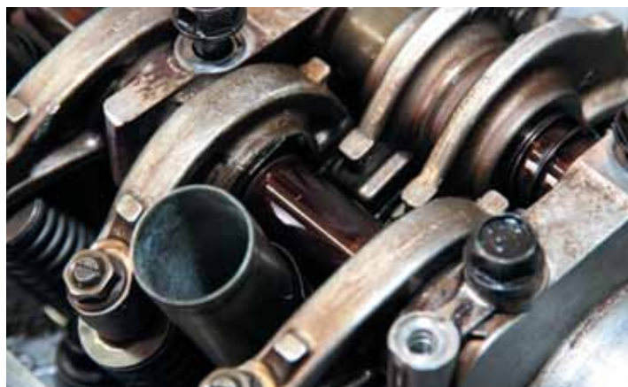
Незначительные лаковые отложения на газораспределительном механизме мотора Honda Civic при пробеге 260 000 км. Владелец авто использовал высококачественные масла. Интервал замены 7000 км. Промывочные масла использовать не требуется.
