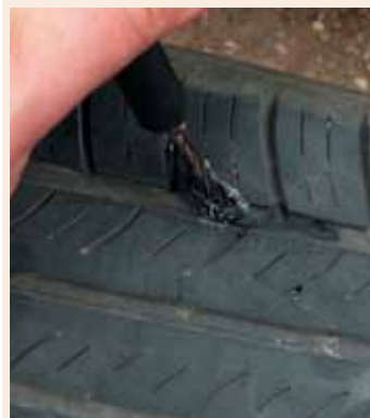
Разрабатывать отверстие необходимо по линии прокола!
