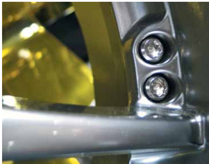
Болты крепления ободов и дисков изготавливаются преимущественно из титана, менять их на стальные нельзя.
