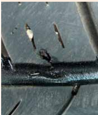
Классический прокол круглым предметом диаметром до 6 мм.
