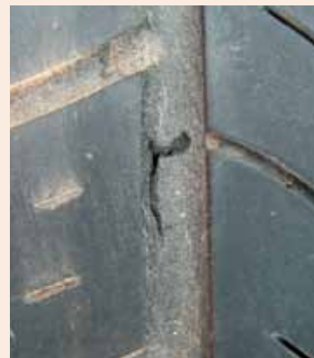
Порез полкрышки плоским предметом. (Ремонт жгутом возможен не всегда)
