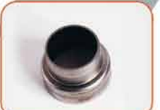
Корпус внутренний верхней опоры стойки передней подвески
