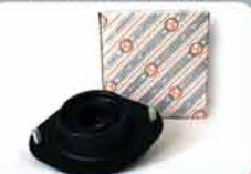
Опора верхняя стойки передней подвески (для автомобиля DAWOO NEXIA)
