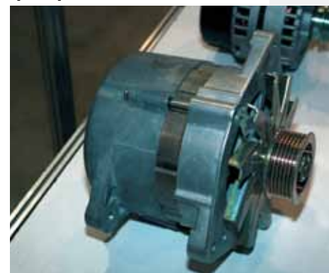
Чем более нагружен агрегат, тем сильнее он нагревается и тем эффективнее должна быть система его охлаждения. Многие зависят от формы крыльчатки.
