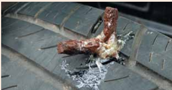
Извлекаем шило аккуратно, чтобы петля не «пошла» вслед за ним. На поверхности остаются кончики длиной оноло 8-10 мм.
