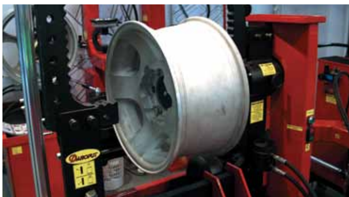
Стенды для правки дисков должны позволять работать с моделями большим посадочным диаметром и шириной обода.
