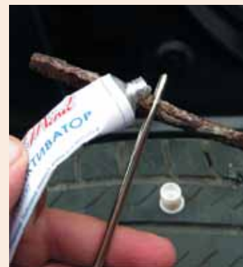
Перед монтажом жгута его необходимо смазать клеем.
