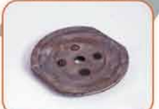
Ограничитель подушки левой опоры двигателя верхний в сборе
