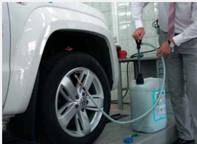
Количество заливаемого герметика зависит от размера шин
