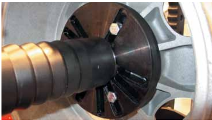
Шпиндель станка для правки дисков должен иметь фланец, позволяющий «посадить» на него диски с любым количеством и расположением монтажных отверстий.
