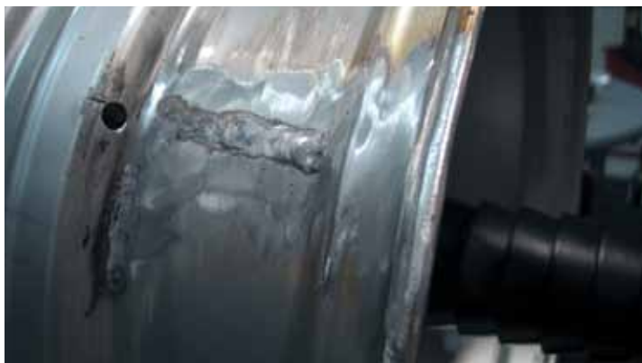
Если диск лопнул пополам – его лучше сдать в пункт приема цветных металлов. Как поведет себя металл с измененной структурой не известно.
