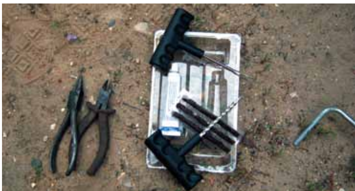
Простой набор ремонта шин: плоскогубцы, кусачки, шило (2 шт.), жгуты и активатор.
