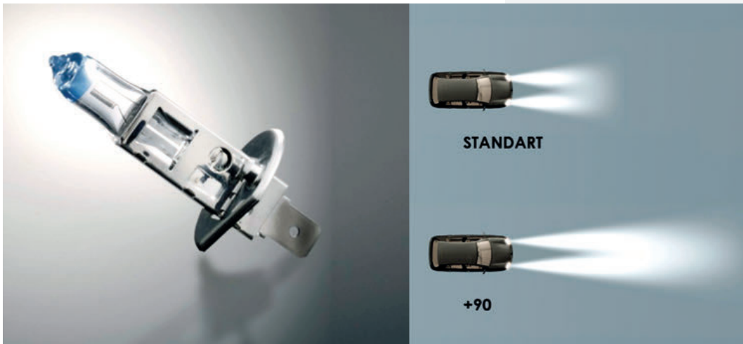
Современная галогенная лампа HELLA HI 12V55W+90% благодаря оптимизированному телу накала, увеличению количества витков внутри нити и нанесению специального покрытия на стеклянную колбу дает до 90 % больше света, чем сравнимые с ней стандартные галогенные лампы
