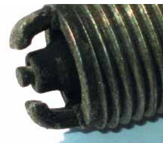
Свеча с двумя боковыми электродами. Центральный электрод слегка приплюснут и напоминает гриб. Закопченный изолятор свидетельствует о том, что с рабочем процессом в цилиндре был неполадок: требуется проведение диагностики. Нагар на свече свидетельствует о проблемах в рабочем процессе.
