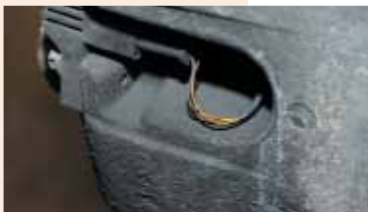
Ревизируя тормозную систему автомобиля, обратите внимание на датчики износа тормозных колодок. Они должны быть исправны, а провода не иметь дефектов оплетки.
