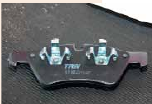
Пружины, входящие в поршни тормозного суппорта, должны быть изготовлены из стойкого к коррозии металла и крепко крепиться к металлической основе колодки.
