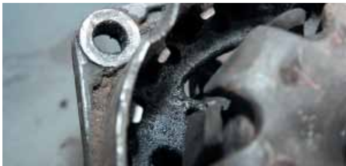
Если на генератор с мотора льется масло, то ожидать от него долгих лет безупречной службы не стоит.
