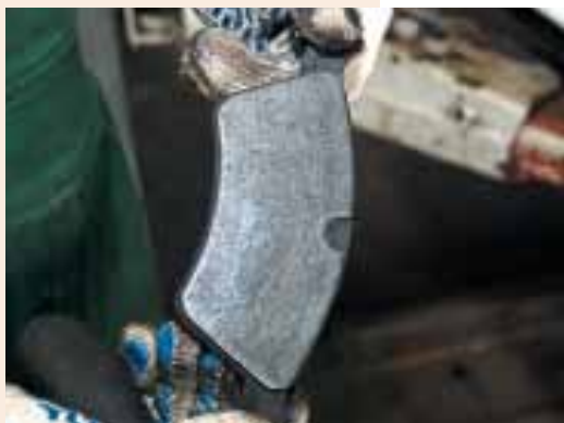
Если тормозные колодки имеют еще достаточную толщину, внимательно рассмотрите их контактные поверхности. На них не должно быть трещин, вырывов фрикционного материала и сколов. Если таковые будут обнаружены – замена обязательна.
