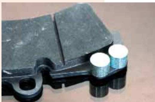
Для снижения уровня высокочастотных вибраций и повышения звукового комфорта на тормозные колодки могут крепиться грузы. На фото тормозная колодка автомобиля Porsche Cayenne.
