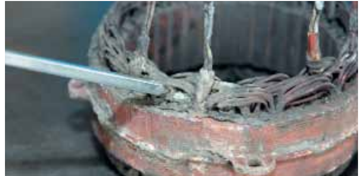
Окислившиеся «жилы» обмотки рано или поздно замкнутся накоротко.
