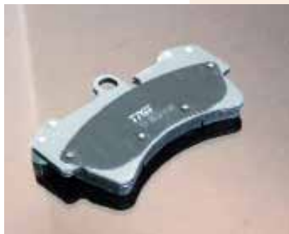
Так выглядят подавляющие высокочастотные вибрации накладки, устанавливаемые на металлическом корпусе тормозных колодок.
