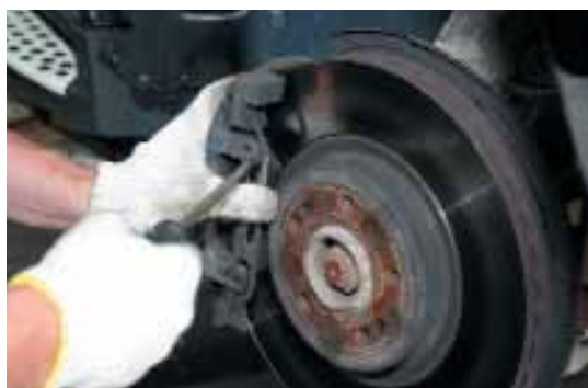
Снимая пружины с суппорта, действуйте аккуратно, так как их можно погнуть или даже сломать, если над ними «потрудились» коррозии.
