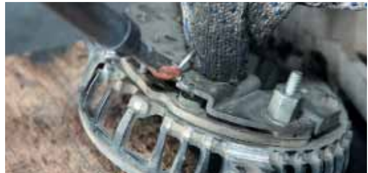
Для пайки контактов необходимо применять соответствующие припои и использовать только исправный инструмент. Защищенное от окалины жало паяльника – хороший тон.
