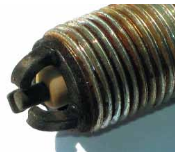
Классическая трехэлектродная свеча с «толстым» центральным электродом. Сочетание надежности, относительной простоты конструкции и невысокой стоимости. Обратите внимание на форму поверхности боковых электродов, обращенную к центральному электроду. О значительном пробеге свечи говорит эрозия (выгорание) боковых электродов. Подгибать их, регулируя зазор нет смысла – проще заменить свечу.
