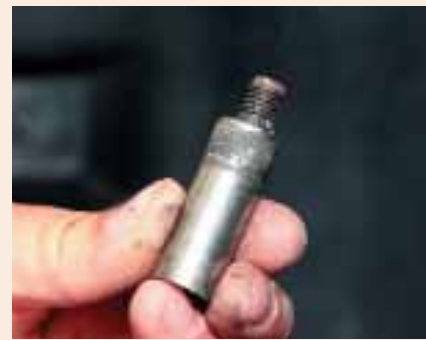
Часто повышенный и неравномерный износ тормозных колодок связан с заклиниванием направляющих из-за разрыва защитных чехлов и коррозии. Перед заменой колодок убедитесь, что данная проблема отсутствует.
