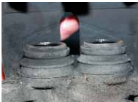
Особое внимание уделяйте целостности резиновых чехлов поршней тормозных суппортов. Как только под них попадет вода или противогололедный реагент, начнется коррозия сменных деталей и потеря подвижности поршней.
