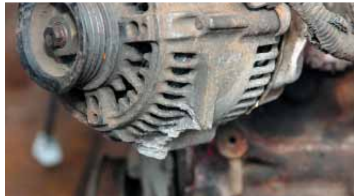
Генератор полностью рабочий, но из-за отломанного «уха» требует замены не дешевой корпусной детали. Обычно такая поломка является следствием дорожно-транспортного происшествия.
