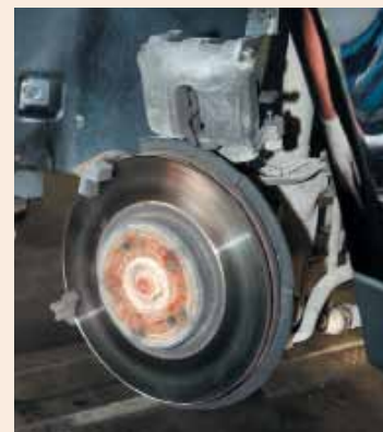
При проведении работ следите, чтобы демонтированный суппорт не висел на тормозном шланге! Для его фиксации можно использовать проволочный крючок или, на крайний случай, веревку.
