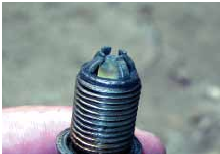
Четырехэлектродная свеча с тонким центральным электродом. Обратите внимание на форму боковых электродов. Такая форма задана с учетом особенности пробоя зазора. Несмотря на наработку в 80 000 км годна и дальнейшей эксплуатации.
