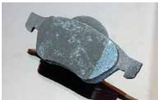
Сношенные края тормозной колодки уменьшают площадь ее контакта с тормозным диском, однако такое техническое решение также направлено на повышение акустического комфорта.
