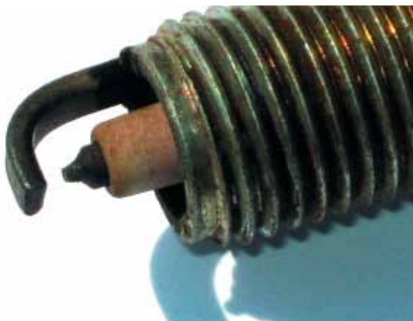
Свеча с тонким центральным электродом обладает улучшенными характеристиками искрообразования. Красноватый оттенок изолятора свечи говорит о том, что машину заправили бензином с железосодержащей присадкой.
