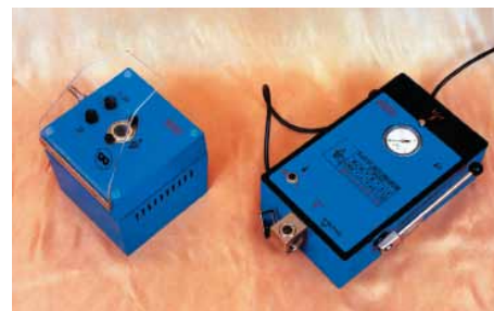
Приборы для очистки и проверки работоспособности свечей зажигания, несмотря на доступность свечей в продаже, все еще востребованы мастерами станций технического обслуживания.
