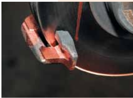
Прежде чем установить новые колодки, нанесите на посадочные места специальную «медную смазку», которая обеспечит подвижность детали в тормозном узле. Если конструкцией предусмотрена специальная пластина, в которую вставляется корпус колодки, то смазку применять не нужно.
