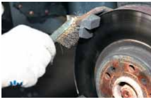
Перед установкой новых тормозных колодок обязательно очищаем посадочные места. Если этим пренебречь, то не исключена потеря подвижности колодки вплоть до ее заклинивания.
