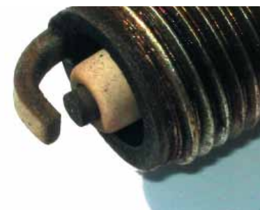
Классическая одноэлектродная свеча – для большинства моторов именно она является оригинальной. Нагар на свече свидетельствует о проблемах в рабочем процессе.
