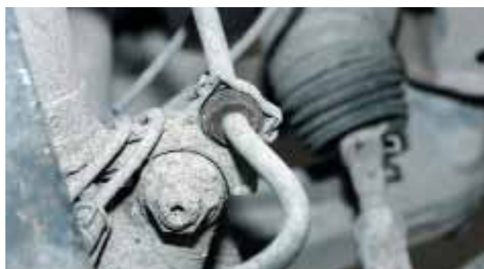
Тормозные шланги не должны иметь трещин и надрывов, в противном случае их необходимо заменить в обязательном порядке. Иначе при экстренном торможении возможен разрыв шланга и разгерметизация тормозного контура.
