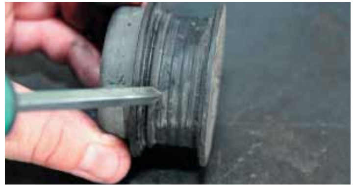
Если контактная поверхность под ремень повреждена или изношена использовать данную деталь нельзя, так как не будет обеспечиваться сцепление ремня со шкивом и не будет реализован требуемый для надежного привода крутящий момент.
