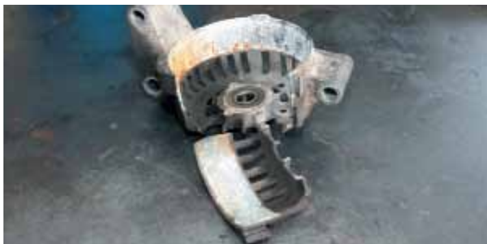
Разломанные корпусные детали не ремонтируются даже при наличии современной аргонодуговой сварки. Только замена на новые.
