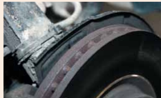
Прежде чем менять колодки, замерьте остаточную толщину тормозного диска. Она должна быть не меньше указанной в инструкции по эксплуатации конкретного транспортного средства. Если диск имеет борозды, то для обеспечения максимального контакта с фрикционным колодкой его необходимо проточить.
