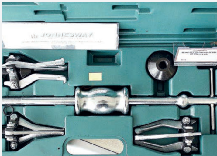
В инерционном съемнике компании Jannesway предусмотрены сменные комплекты лапон, позволяющие демонтировать подшипники различных размеров
