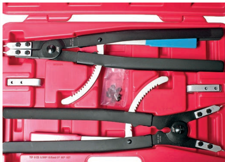
Съемники для наружных и внутренних стопорных колец компании JTC – необходимый технологический компонент при замене ступичных подшипников
