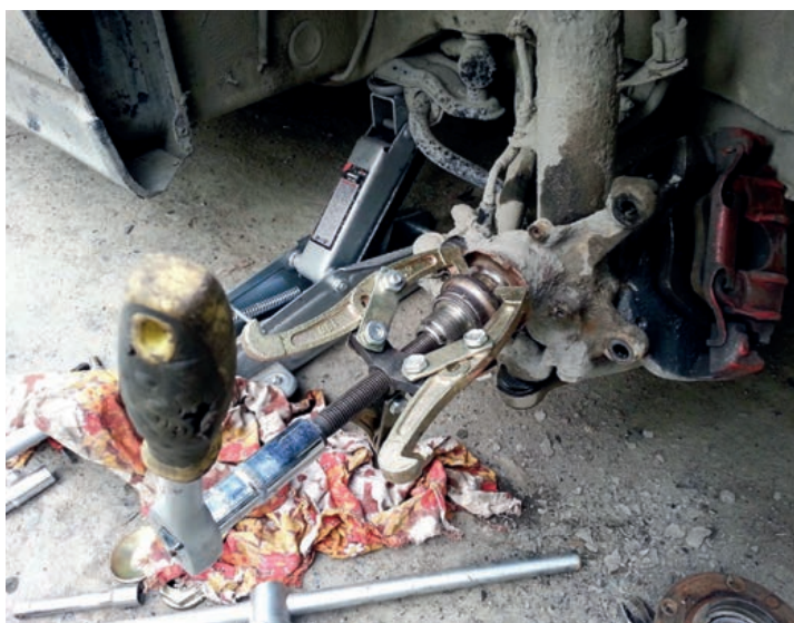
Оставшееся от разрушенного подшипника внутреннее кольцо сепаратора необходимо спрессовать с помощью съемника производства компании JTC
