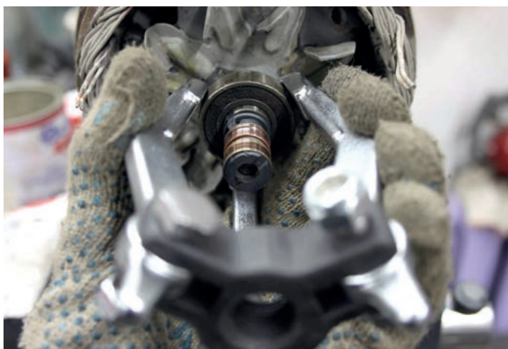
Трёхзахватные винтовые съёмники предприятия «Энерпред» позволяют быстро и без перекосов снять подшипник генератора...
