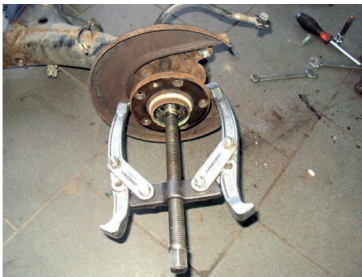
Снять ступицу на VW Beetle быстро и качественно можно с помощью универсального съемника Jonnesway
