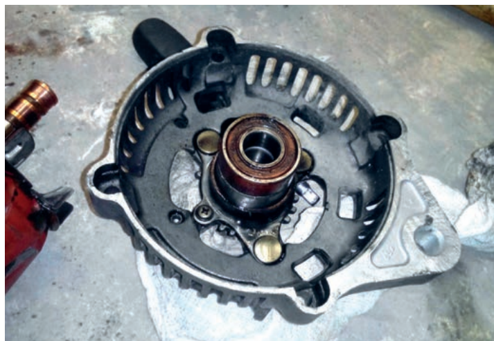
При отсутствии гаражного прессы запрессовывать новый подшипник можно, используя в качестве оправки, в которой прикладывается усилие, старый, демонтированный, подшипник
