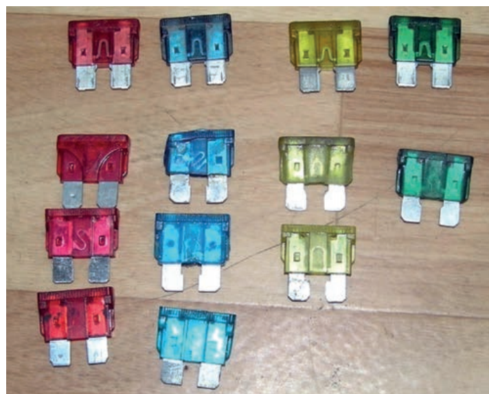
В автомагазинах массово предлагаются «неперегорающие» предохранители. На фото верхний ряд – это качественные фланцевые предохранители, а ниже – подделки из КНР
