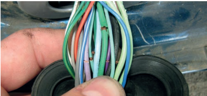
Эксплуатация автомобиля с низковольтными проводами, имеющими разрывы изоляции во многих местах, грозит немалыми проблемами водителю
