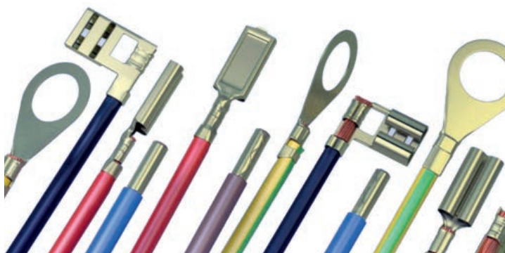
Наконечники на проводах применяются в основном двух типов - подвижные крепления, с диаметром отверстия, превышающим на 0,2-0,5 мм диаметр винта крепления, и плоские штекеры толщиной 0,2-0,5 мм и шириной 2,8-3,5 мм
