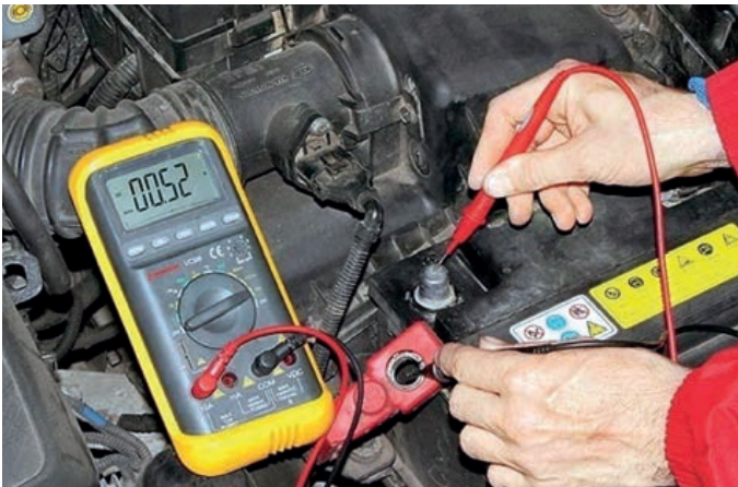
Проверка цепи АКБ с помощью мультиметра, переключенного в режим амперметра, показывает, что утечек тока нет, потребление в пределах нормы
