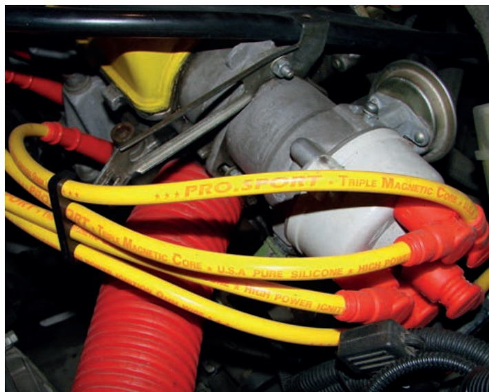
Высоковольтные провода напряжения имеют высокие диэлектрические свойства, провода сохраняют эксплуатационные качества длительный срок, несмотря на нахождение в моторном отсеке, где наблюдаются температурные перепады, влажность, запыленность
